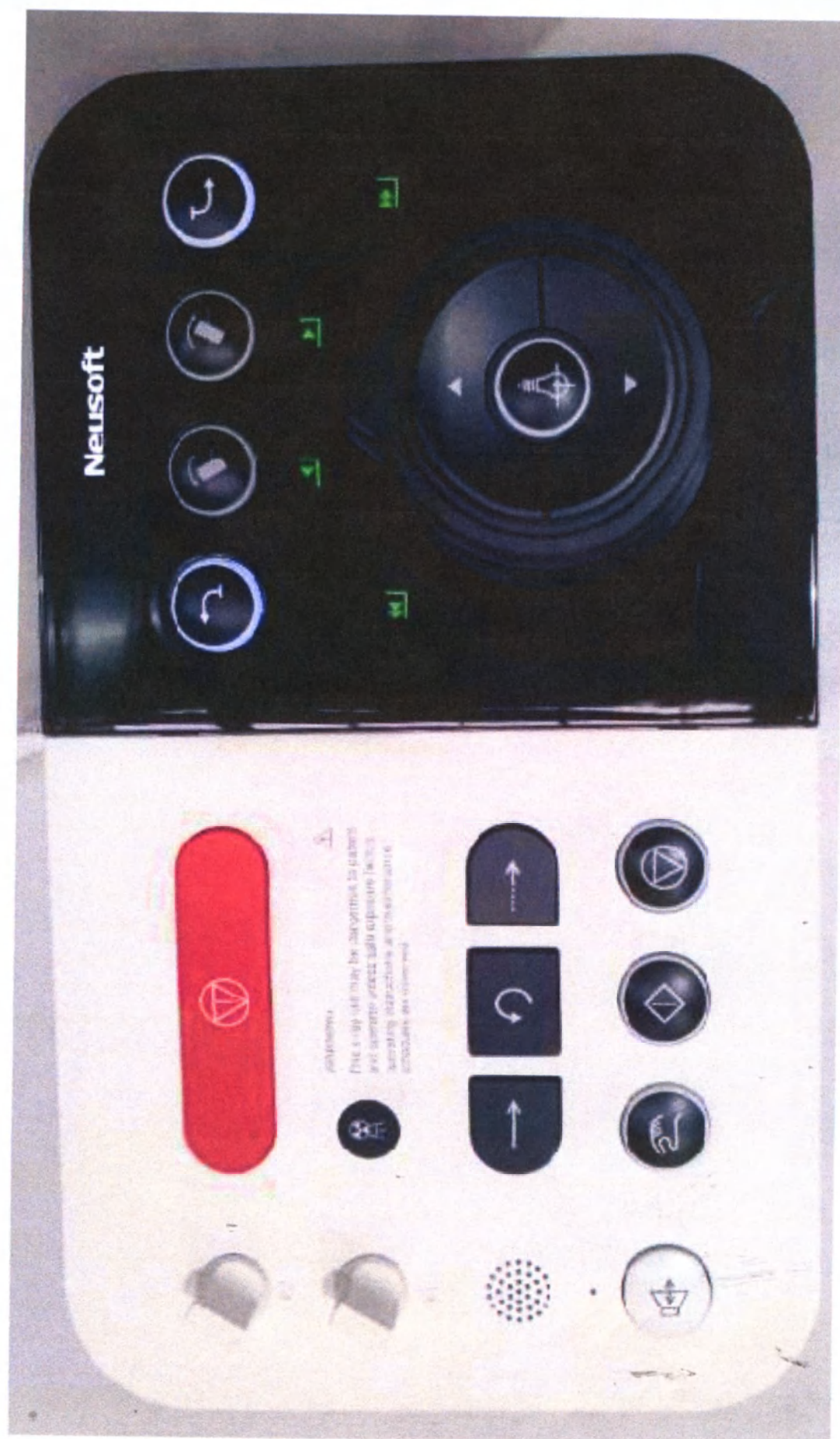
Пульт управления СТ-BOX 14107331. Общий вид
