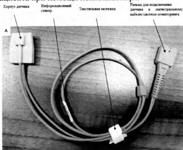
Рис. 16. Датчик SpO 2 детский, тип варежка. А - общий вид, Б - корпус датчика.
