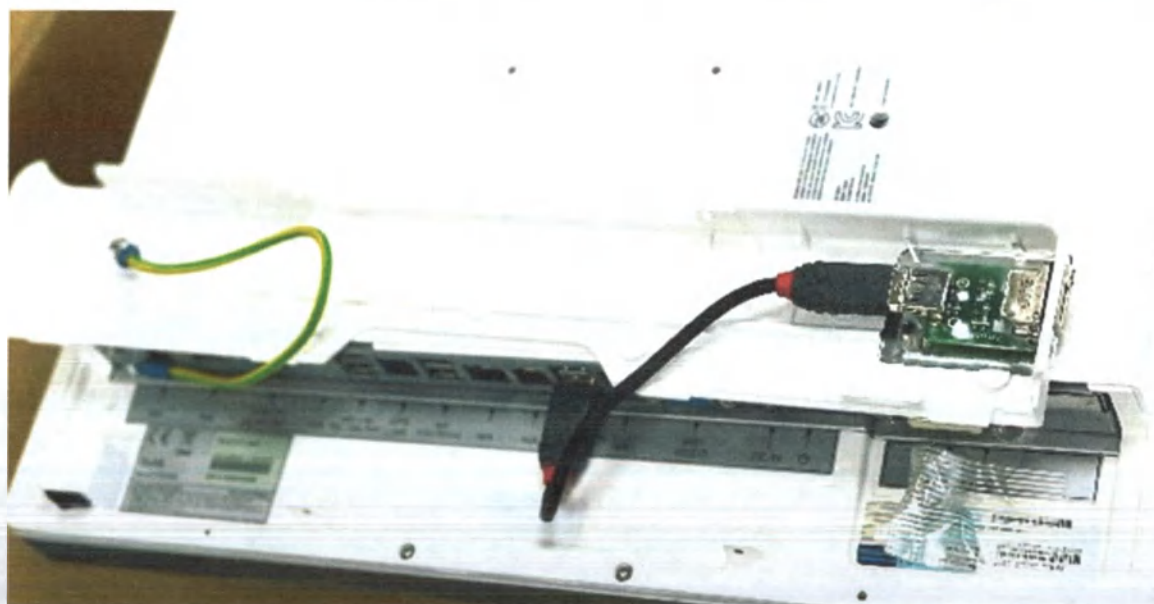
Цифровой интерфейс M с USB кабелем и портом с винтами
