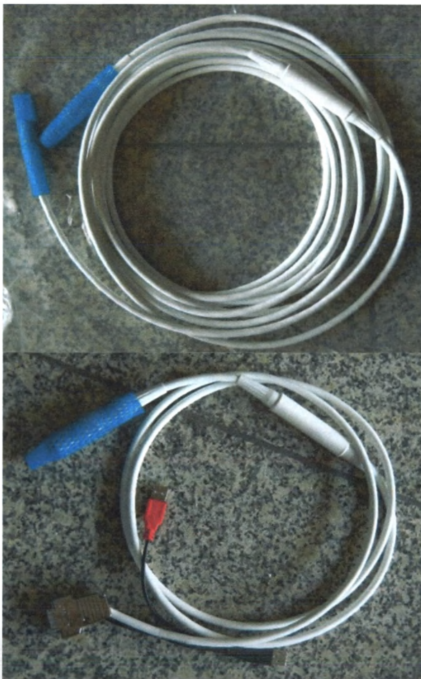
Кабель модуля микроскопного с разъемами VGA/USB и LEMO – 10 м
