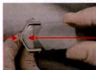
Сапфировая пластина вынимается для очистки
