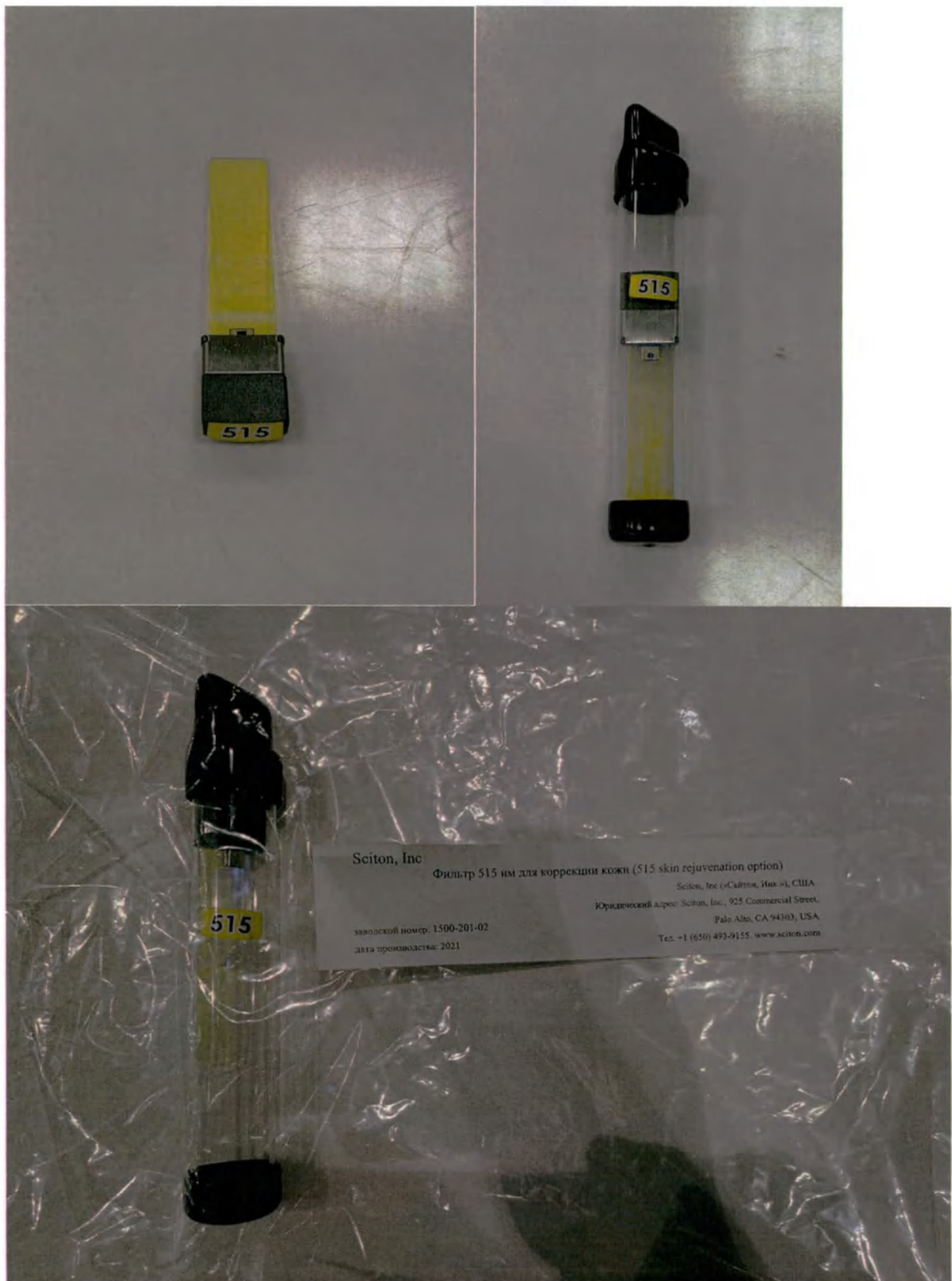
11. Фильтр 515 нм для коррекции кожи (515 skin rejuvenation option) – 1 шт.; Световой фильтр из сапфирового стекла. Отсекает световой спектр вокруг длины волны 515 нм. Используется для коррекции кожи
