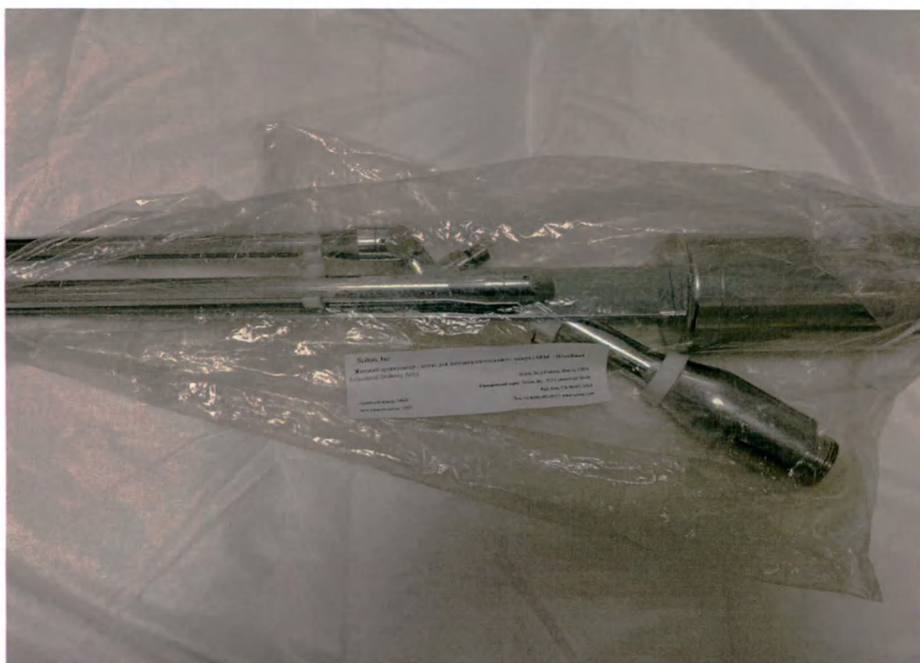
5. Жесткий артикулятор - плечо для доставки интенсивного лазера (ARM – Broadband Articulated Delivery Arm) – 1 шт.; Металлический артикулятор для доставки лазерного излучения
