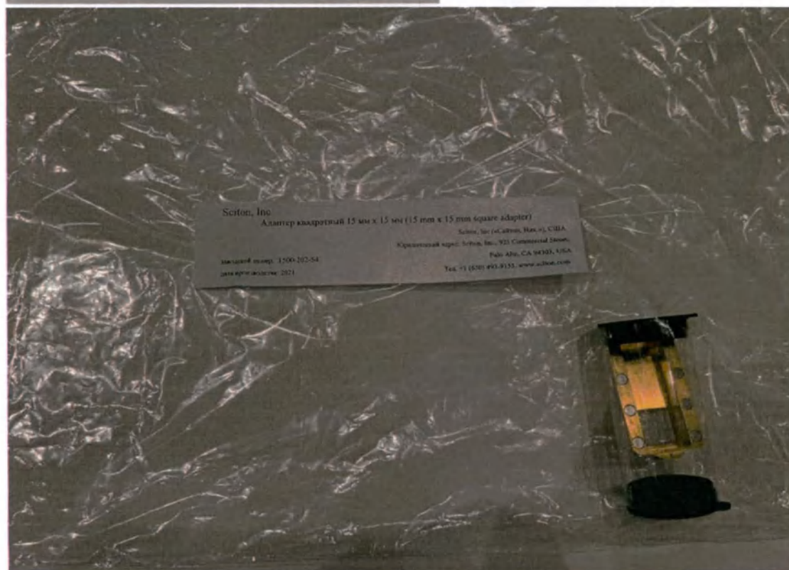
21. Адаптер квадратный 15 мм x 15 мм (15 mm x 15 mm square adapter) – 1 шт.; Позолоченный адаптер с сапфировым стеклом квадратного сечения 15 мм на 15 мм. Используется для ограничения площади воздействия пульсирующим светом
