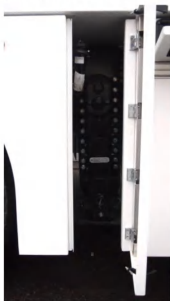
Рис. 6 «Резервный ввод питания для подключения к внешнему источнику питания»
