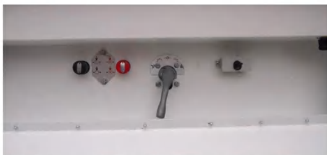
Рис. 11 ««ПКД 7». Тормоз шасси ПМК – кнопка красного цвета»
