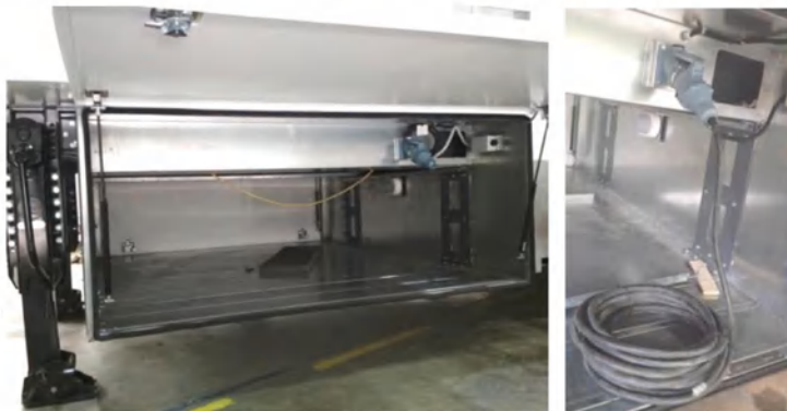
Рис. 6 «Резервный ввод питания для подключения к внешнему источнику питания»
