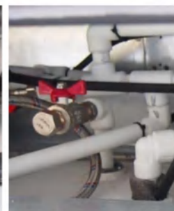
Рис. 9 ««ПКД 5». Диафрагменный насос и заливной штуцер для заливки воды в бак «чистой воды»»
