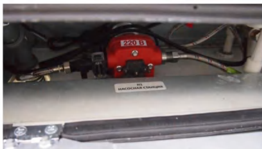
Рис. 9 ««ПКД 5». Диафрагменный насос и заливной штуцер для заливки воды в бак «чистой воды»»
