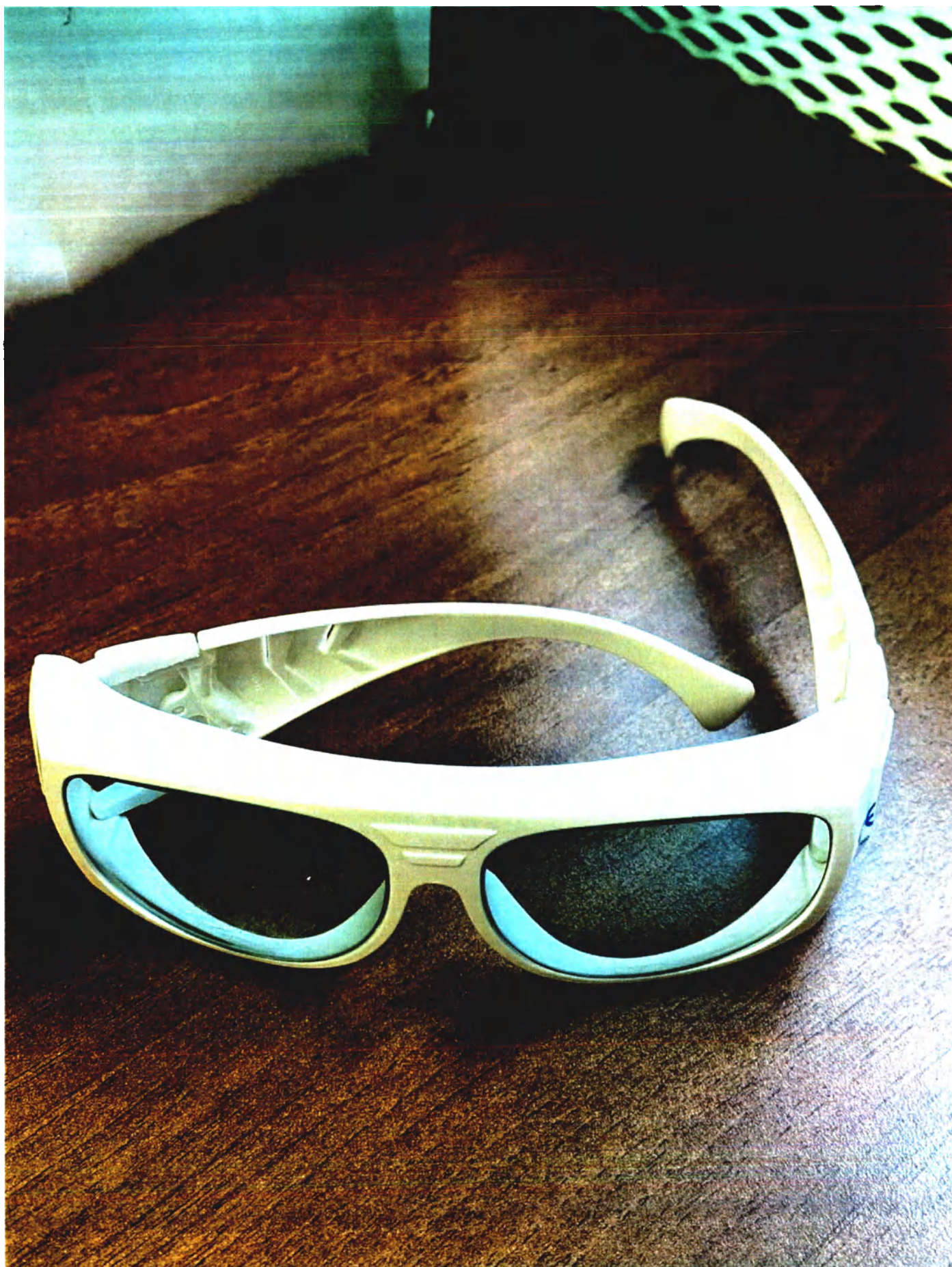
Очки Lutronic для защиты оператора от лазерного излучения.
