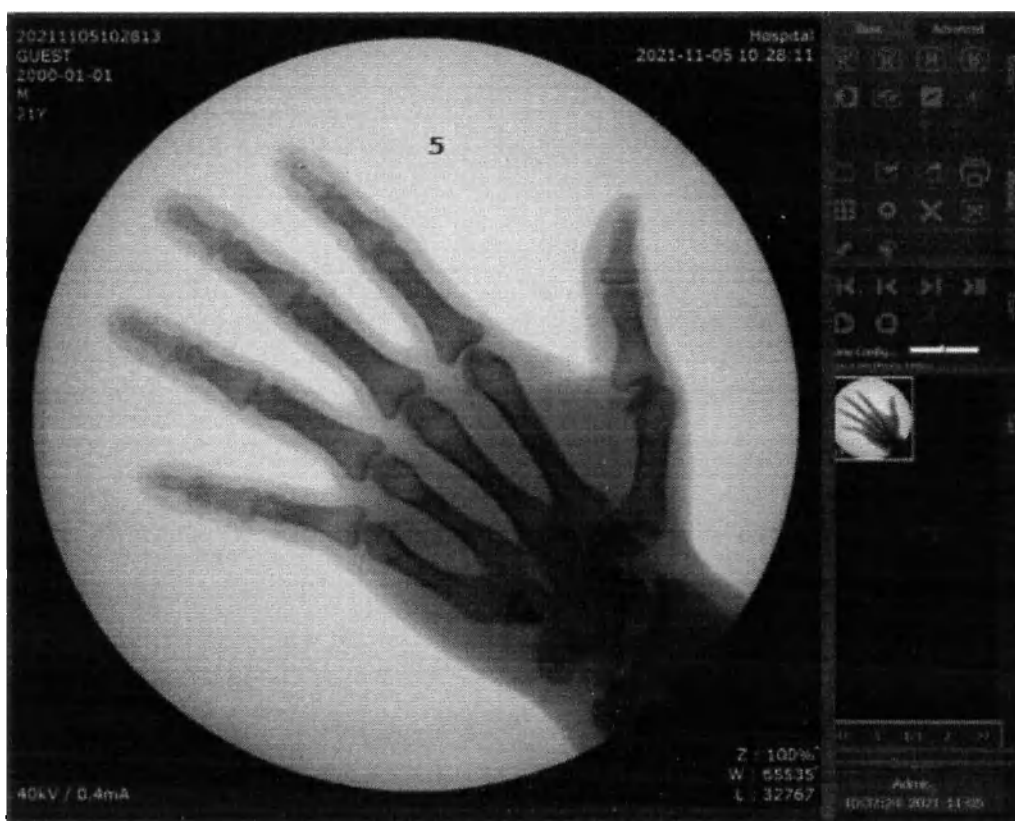
Рисунок 81.1 Средство просмотра контрольного снимка — Исполнение 1 (с усилителем рентгеновского изображения)
