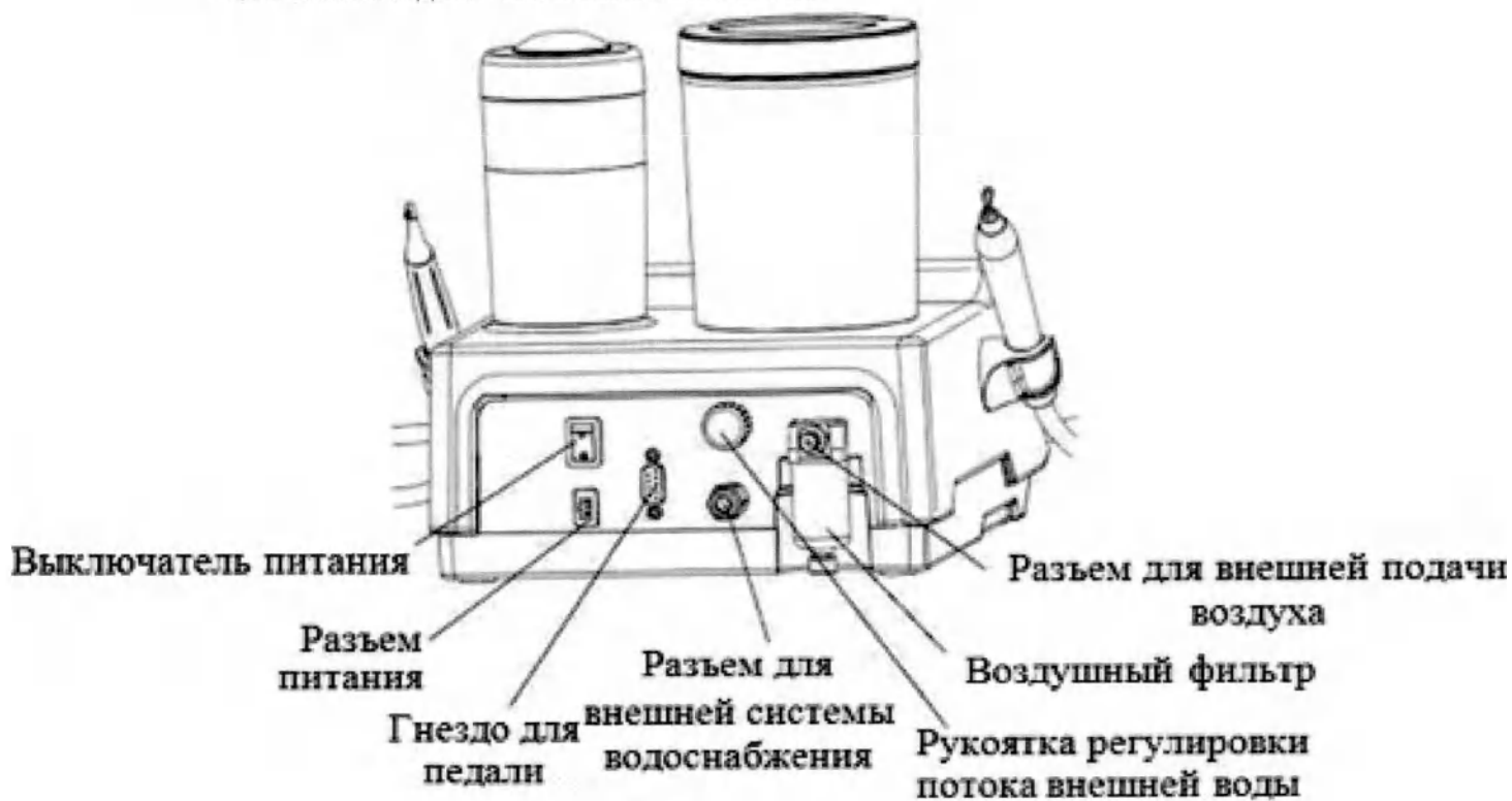
Рисунок 2 – Вид основного блока сзади
