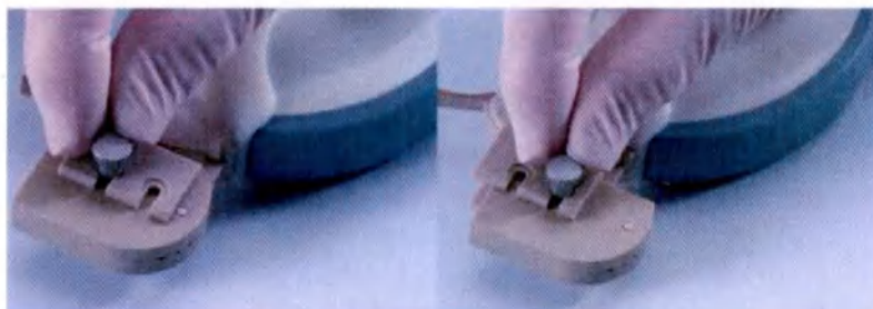
Рис. 13 Установка опор для ультразвукового датчика СА541.
