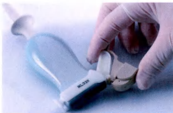
Рис. 10 Установка опор для ультразвукового датчика LA332.
