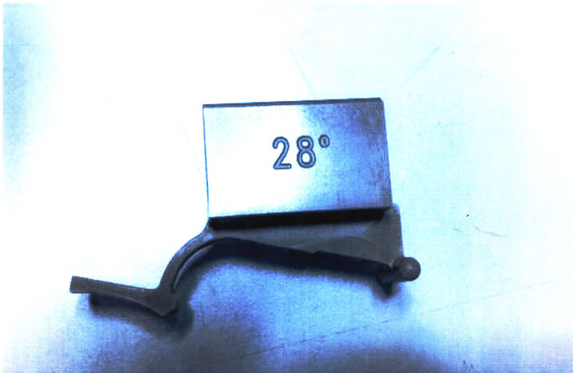
Фото 19. Набор опор направляющих многоугольных для ультразвукового датчика СА541: опора для направляющего блока, угол 28^\circ .
