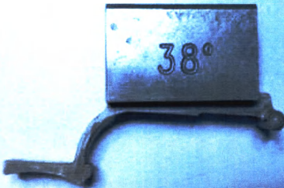
Фото 20. Набор опор направляющих многоугольных для ультразвукового датчика СА541: опора для направляющего блока, угол 38^\circ .
