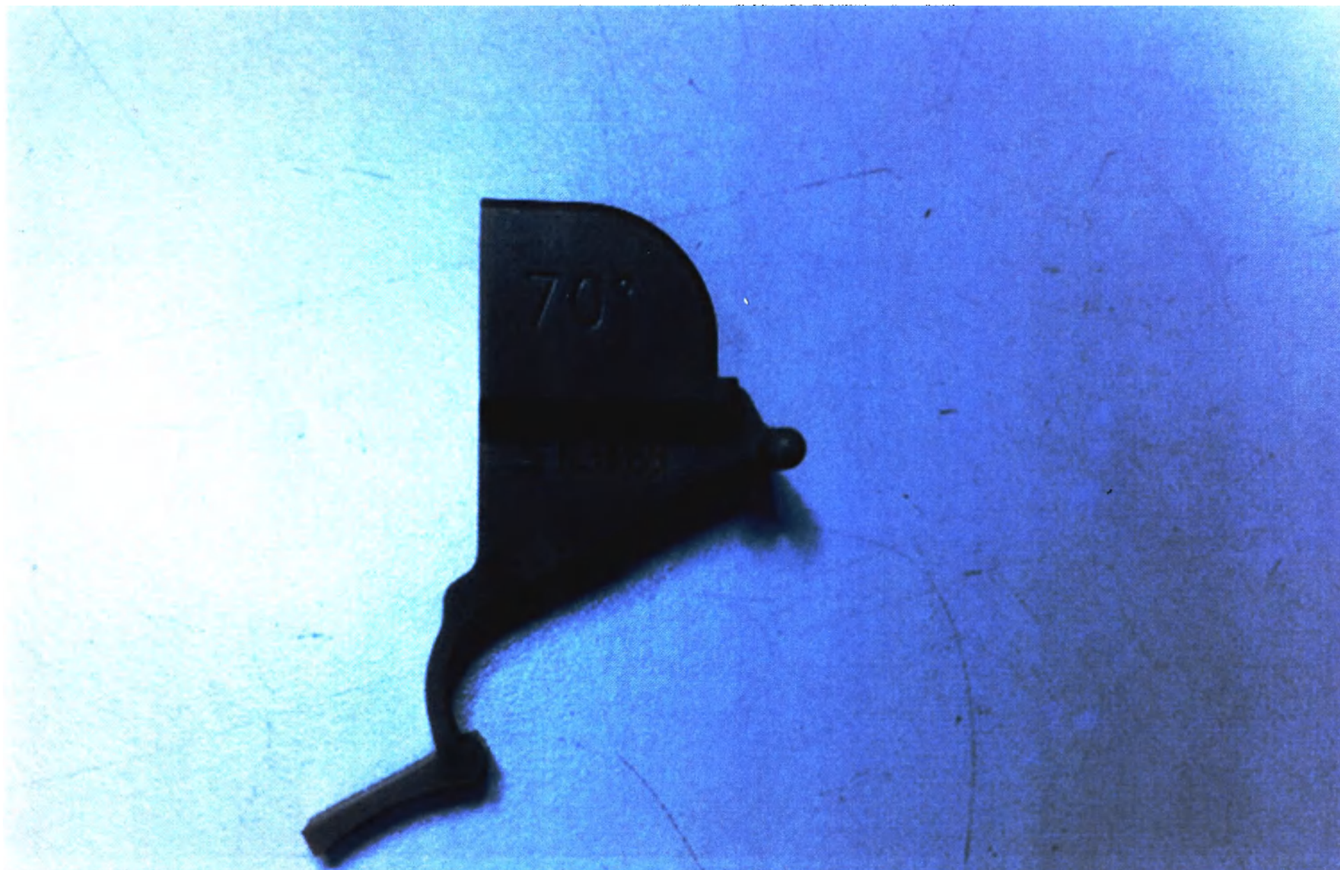
Фото 11. Набор опор направляющих многоугольных для ультразвукового датчика LA332: опора направляющая, угол 70^\circ .
