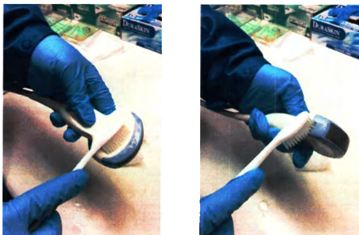
Рисунок 5-4 Чистка датчика щеткой
