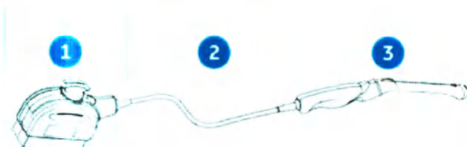
Рисунок 5-3 Проверьте линзу, кабель и корпус датчика после каждого использования.
