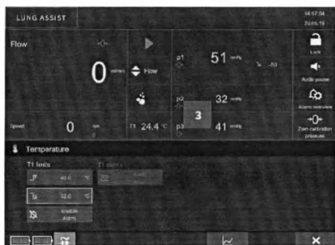
Рисунок 135 – Установка пределов датчиков температуры T1/T2 в профиле терапии ПОДДЕРЖКА ЛЁГКИХ
