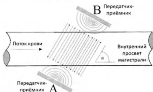
Рисунок 26 – Схема работы принципа Доплера
