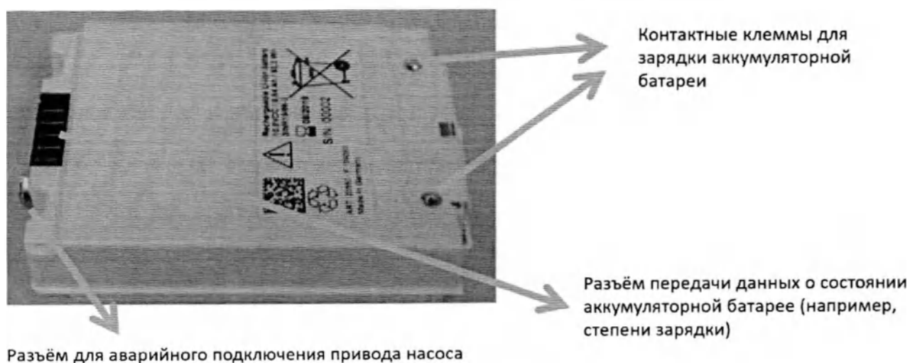
Рисунок 20 – Аккумуляторная батарея (вид сзади)
