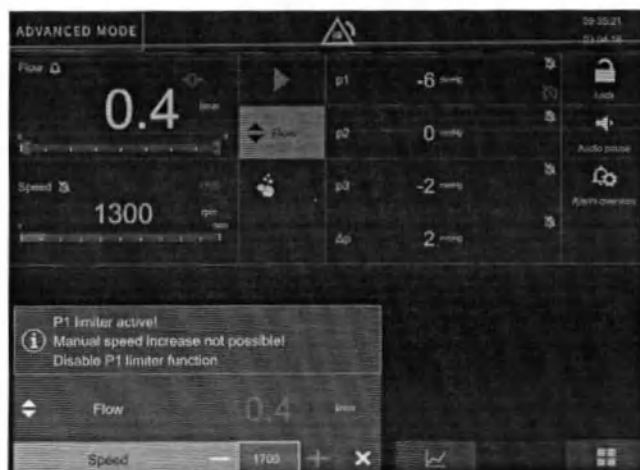
Рисунок 127 – Принцип работы ограничителя p1
