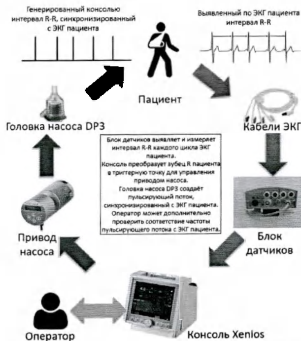
Рисунок 5 - Функциональная схема режима «СИНХРОНИЗИРОВАННАЯ ПОДДЕРЖКА СЕРДЦА» (Synchronized Cardiac Assist / SCA)
