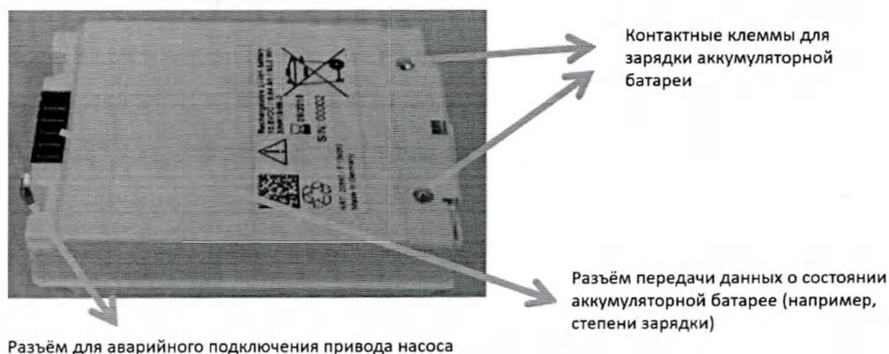
Рисунок 21 – Аккумуляторная батарея (вид сзади)
