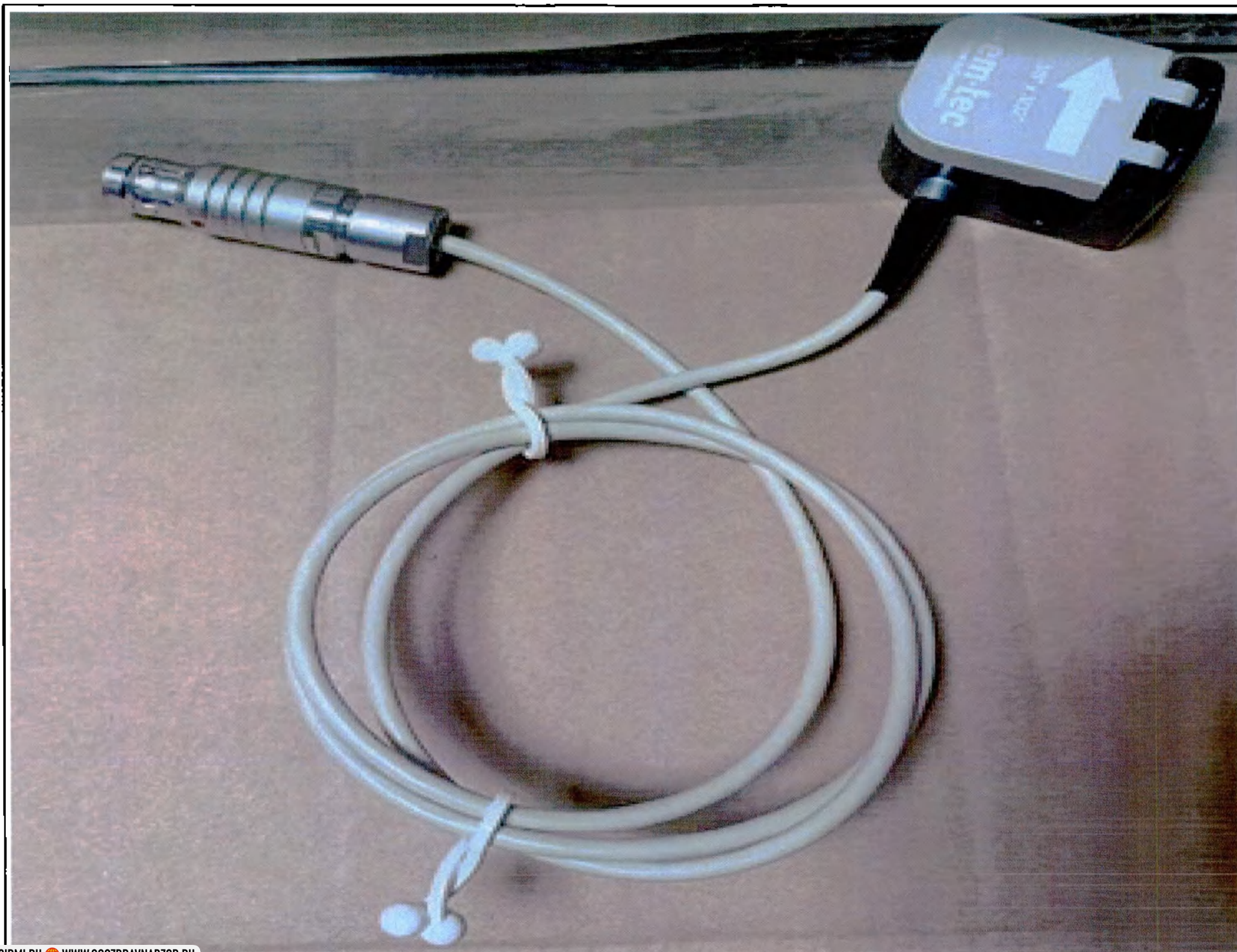
Датчик потока 3/16 x 1/16, производства em-tec GmbH, Германия (Flow sensor 3/16 x 1/16)
