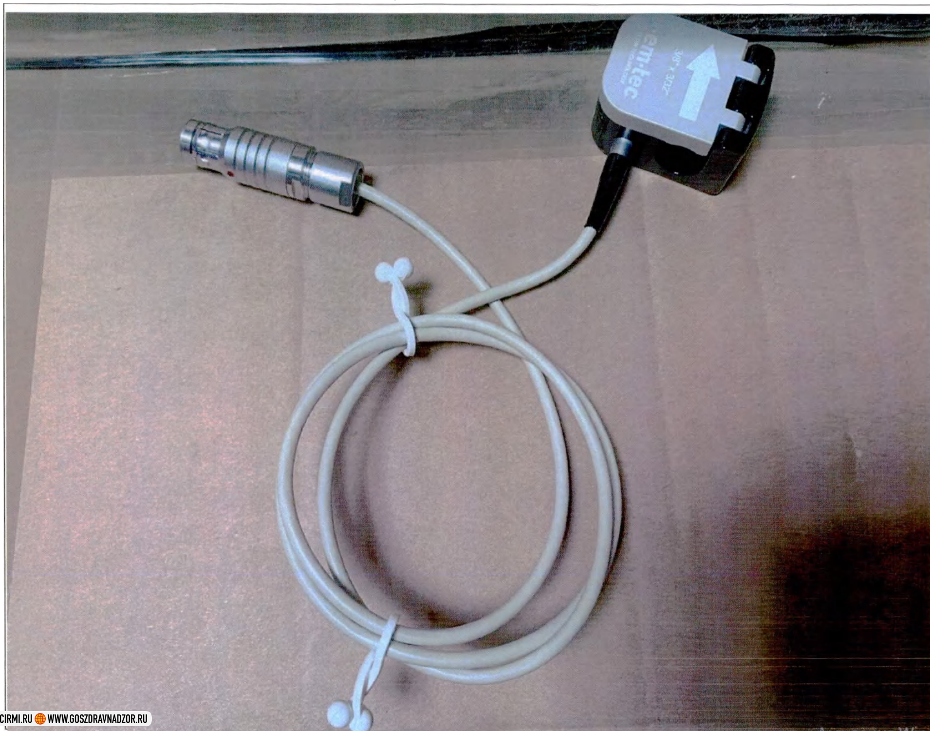
Датчик потока 3/8 x 3/32 , производства em-tec GmbH. Германия (Flow sensor 3/8 x 3/32)
