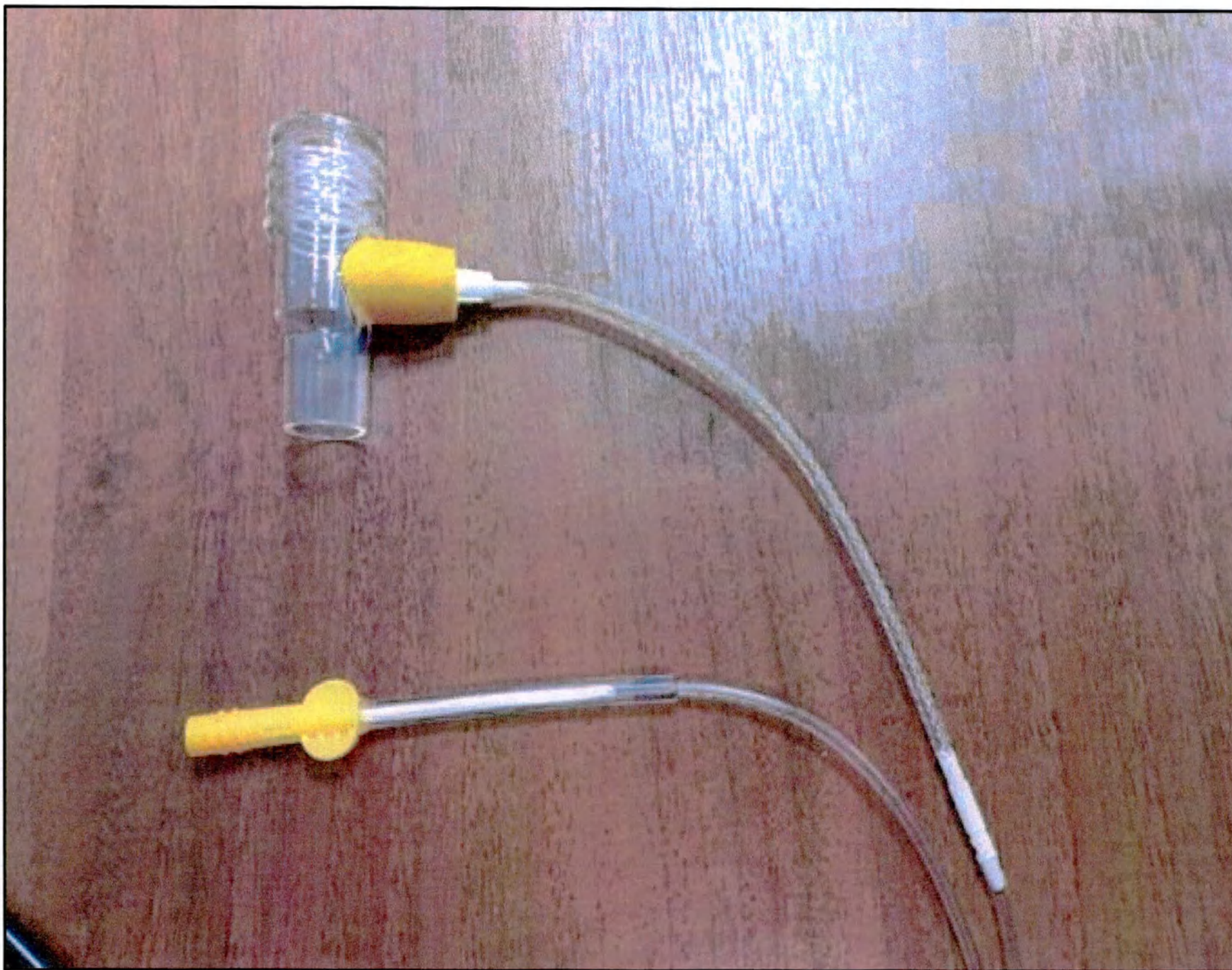
Линии отбора газов
