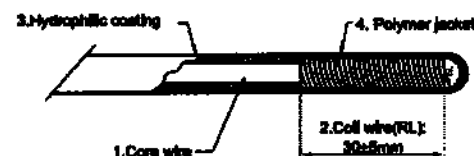
Рис. 4 Схематичный чертеж микропроводника внутрисосудистого Shun Tranpass / Fig. 4 Structure of Intravascular micro guidewire Shun Tranpass
