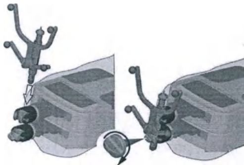
Рис. 34: Установка трекера Stealth Autoguide™ в направляющие вставки
