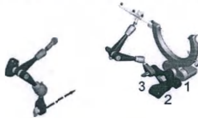
Рис. 19: Монтаж держателя для позиционирования Autoguide
