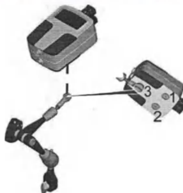
Рис. 20: Монтажные точки на механизме нацеливания Autoguide
