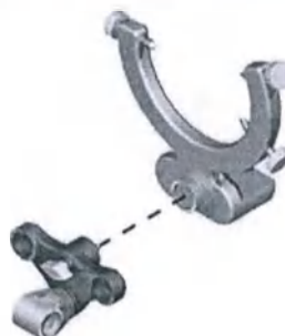
Рис. 17: Сборка адаптера фиксатора головы Autoguide и муфты
