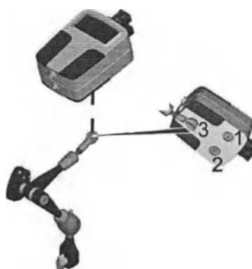
Рис. 23: Три монтажные точки на механизме нацеливания Autoguide
