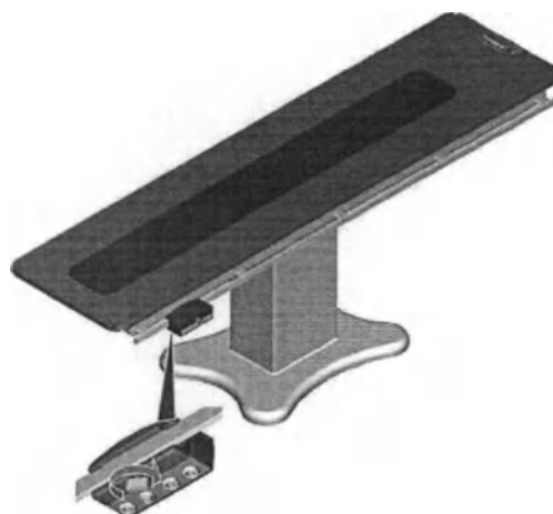
Рис. 15: Монтаж блока уменьшения натяжения Autoguide
