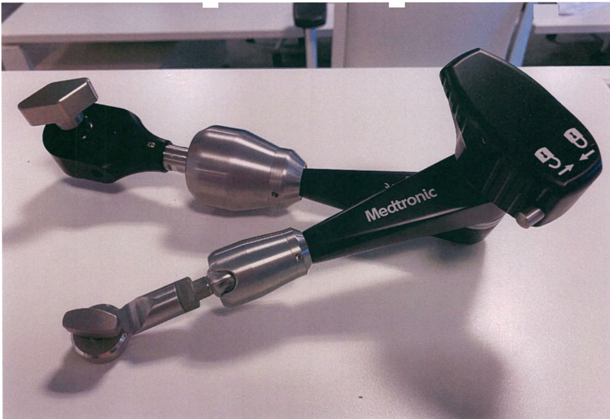
Фото 9. Держатель для позиционирования Autoguide
