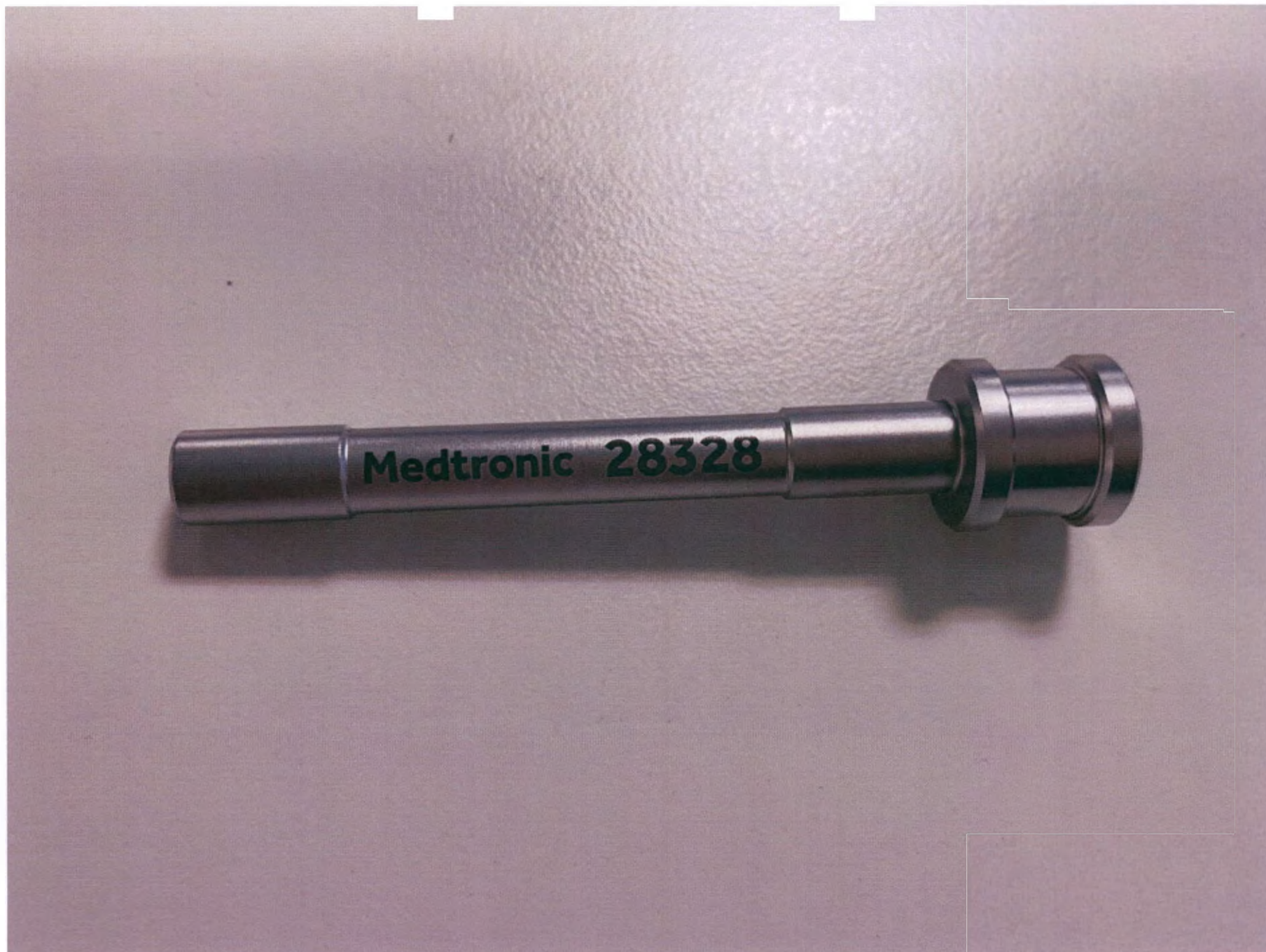
Фото 24. Уменьшительная трубка для проведения стереоэлектроэнцефалографии Autoguide (4,0 мм)
