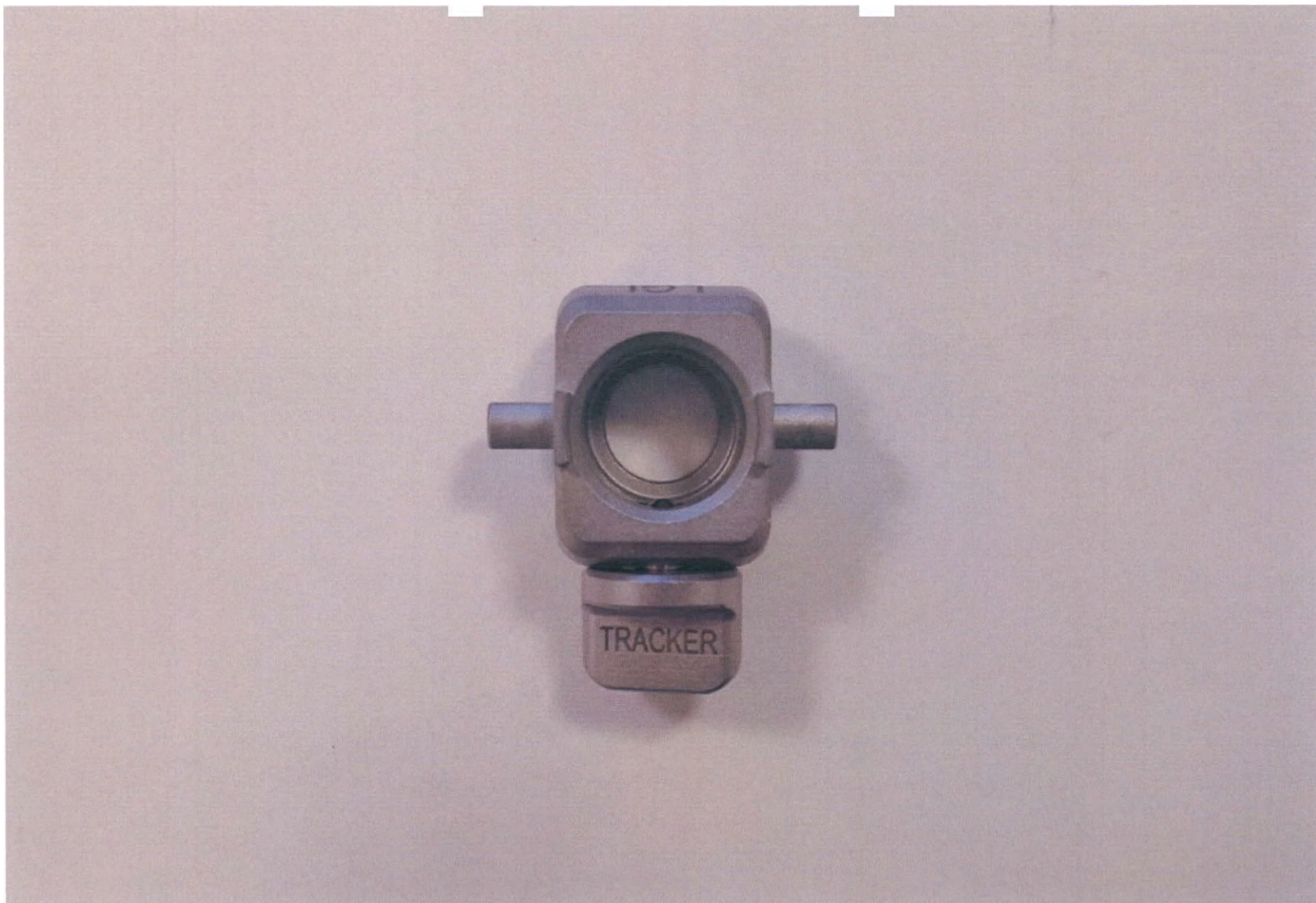
Фото 14. Нижняя направляющая вставка Autoguide
