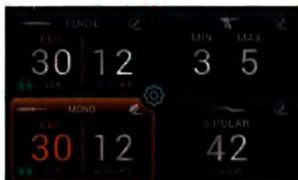
Рисунок 26 - Активация режима Разрез (CUT-Cutting) электрода лапароскопического монополярного, крючка в режиме Лапароскопического монополярного разреза (Laparoscopic Mono-Cut).
