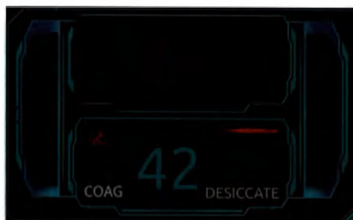
Рисунок 21 - Активация режима Коагуляция (COAG – Coagulating) рукоятки для монополярных электродов SCPen.
