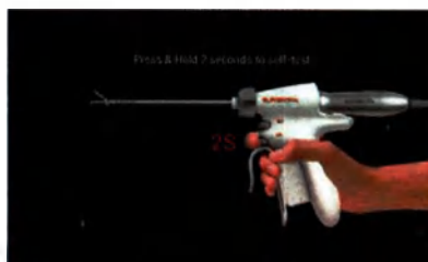
Рисунок 29 - Самопроверка ультразвукового скальпеля
