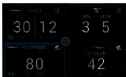
Рисунок 25 - Активация режима электрода лапароскопического монополярного, крючка в режиме Многофункционального ножного переключателя (Multi-footswitch).
