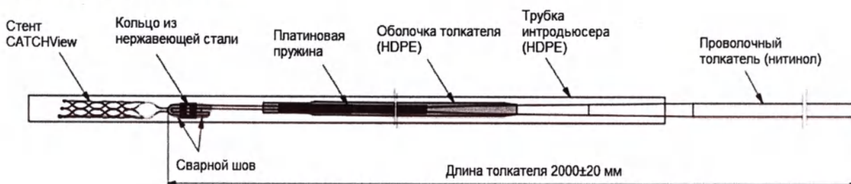
Рис.1. Схематическое изображение Системы CATCHView
