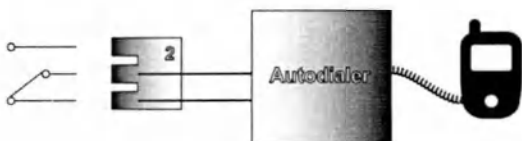
Подключение устройства автодозвона к разъему "Сигнализация 2"
