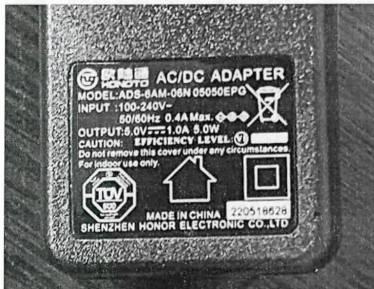
Пример маркировки блока электропитания, модель ADS-6AM-06N 05050EPG
