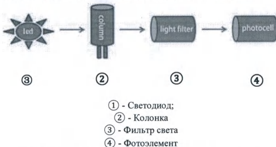
Рис. 3.2.2.2 Принцип колориметрического анализа
