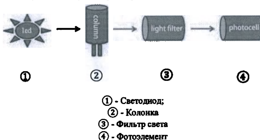
Рис. 3.3.2.2 Принцип колориметрического анализа
