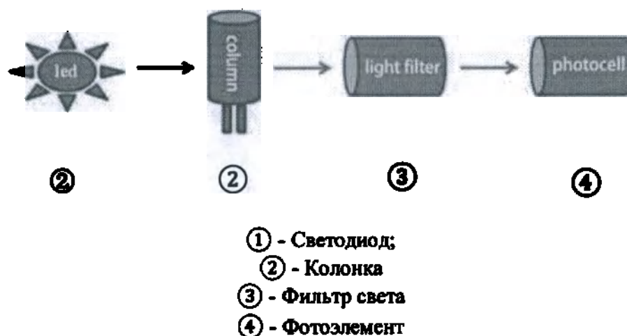
Рис. 3.2.2.2 Принцип колориметрического анализа
