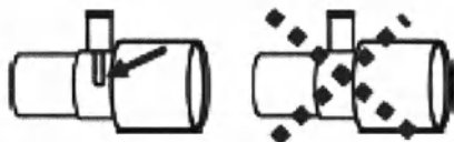
Рисунок 2. Для оптимальной обработки воды необходимо использовать Т-образные адаптеры с точкой отбора проб в центре адаптера, как показано слева выше.
