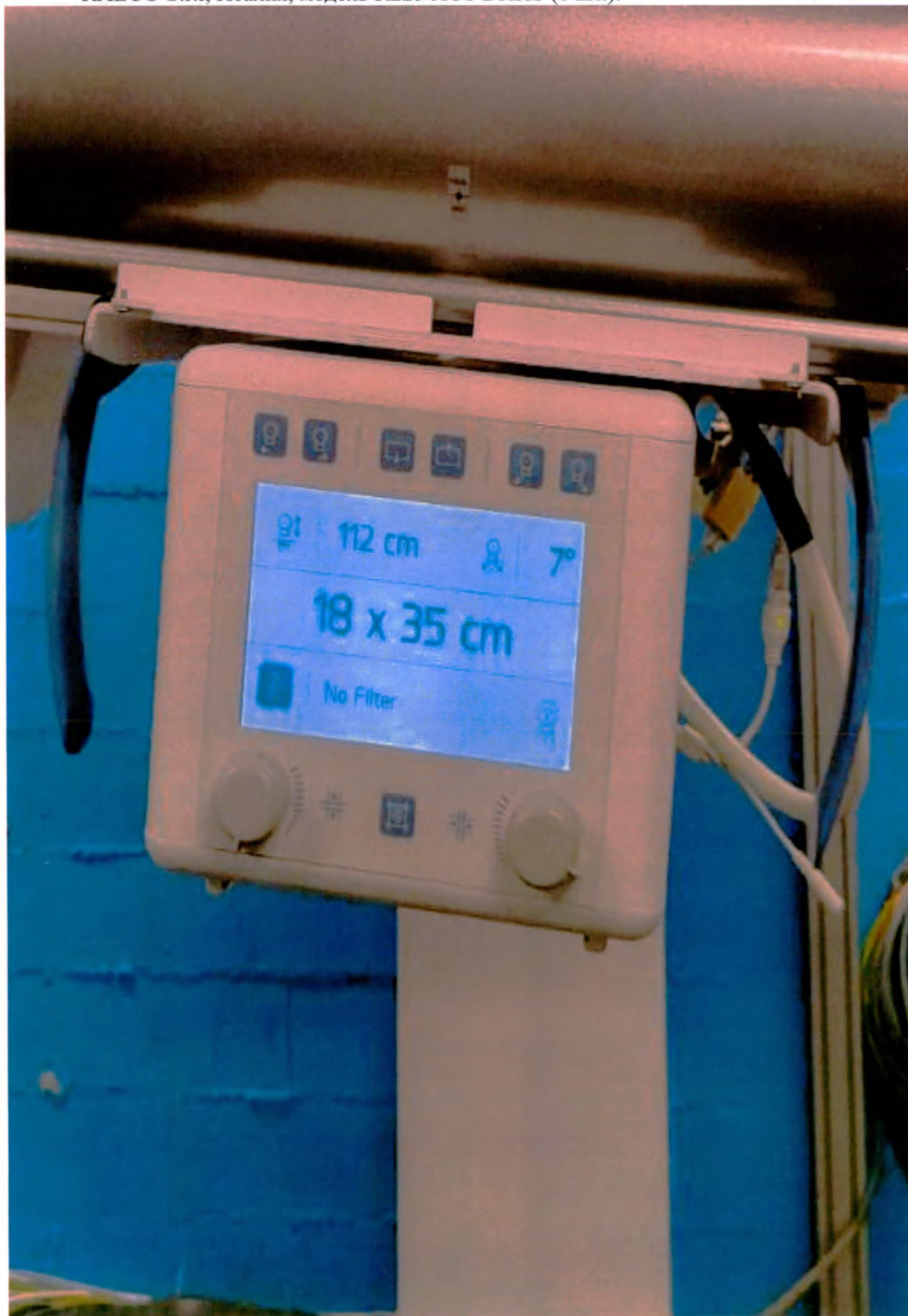
1.1. Коллиматор для рентгеновского излучателя стола-штатива, производства компания RALCO S.r.l, Италия, модель R225 ACS DHHS (1 шт.).
