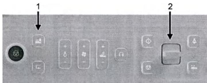
Рис. 57: Модуль пользовательского интерфейса (UIM). 1. Кнопка «Вручную». 2. Тумблер.
