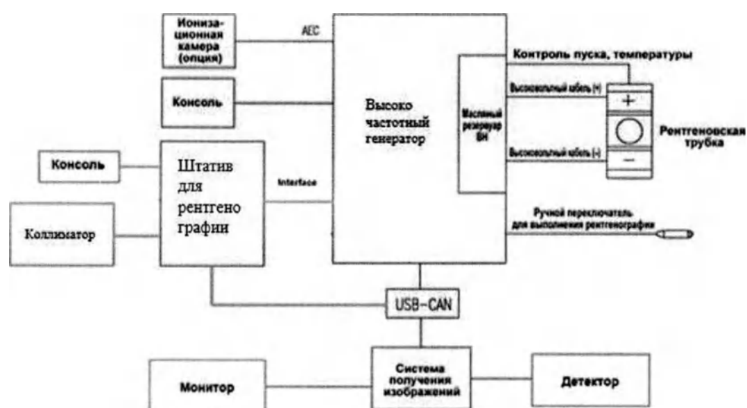
Рисунок 2 Электрический принцип работы
