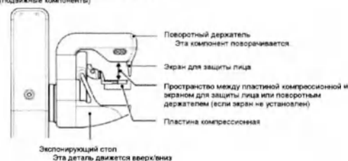
Опасные компоненты на штативе аппарата (подвижные компоненты)
