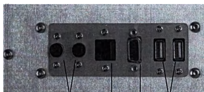
Порты PS/2 для клавиатуры и мыши Сеть (Ethernet) Монитор (VGA) USB-порт
