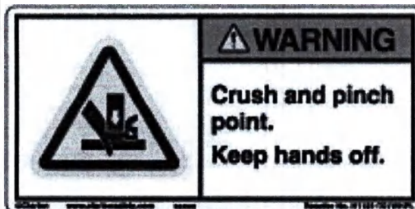
Рис. 1.2. Предупреждающая надпись: «Внимание! Зона сдавливания»
