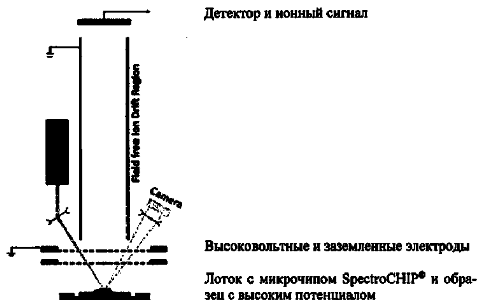
Рис. 2.1. Общая схема процедуры с помощью MALDI-TOF MS
