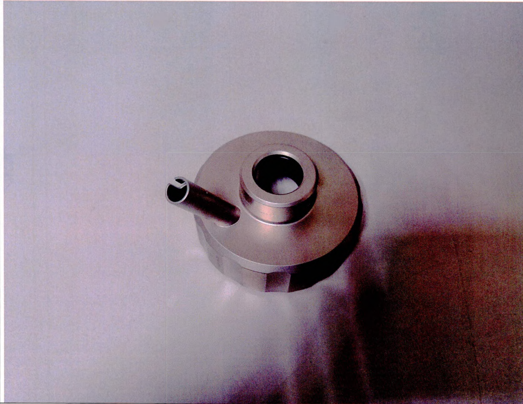
Рис. 33. Заглушка с держателем для осветительного стержня, диаметр 5 мм
