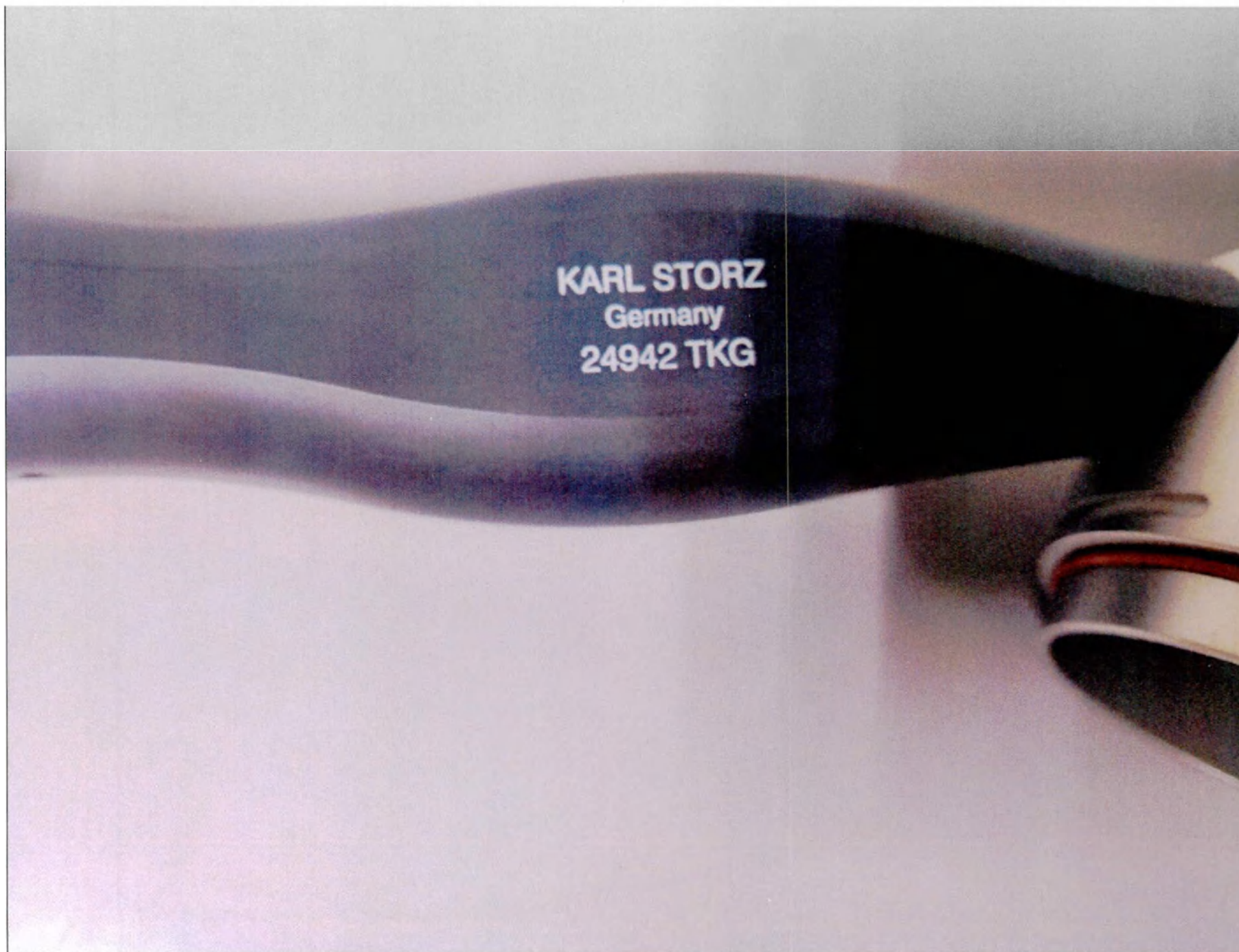
Рис. 2. Тубус операционного ректоскопа ТЕО, с рукояткой, прямой наконечник, диаметр 40 мм, рабочая длина 7,5 см
