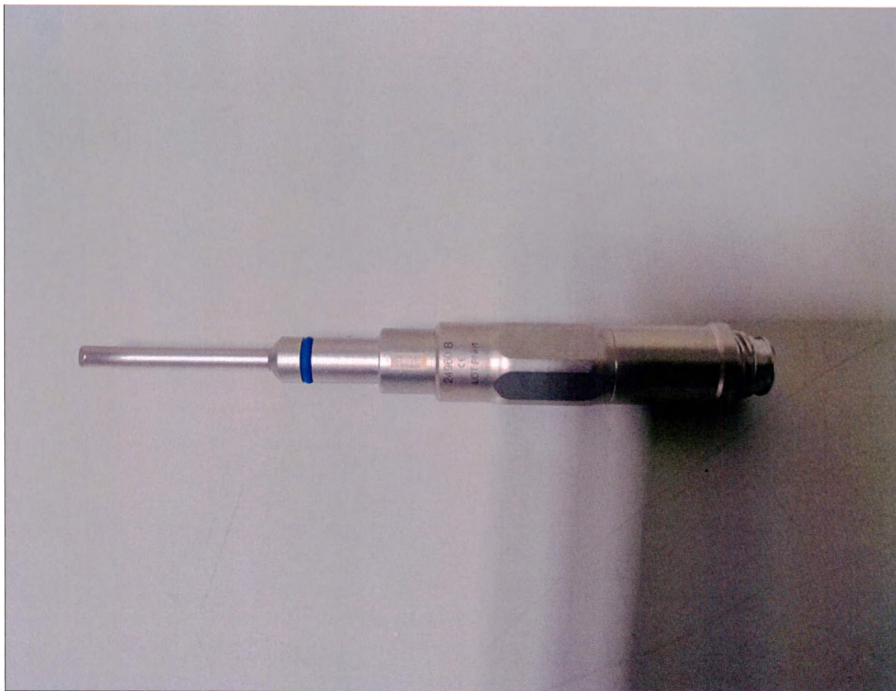
Рис. 31. Стержень осветительный с соединением для волоконнооптического световода, длина 9 см
