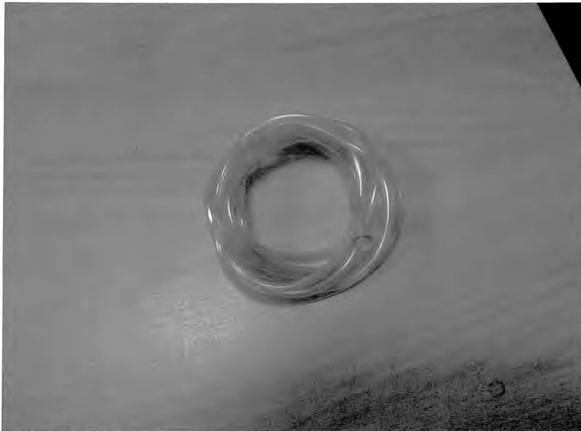
Рис. 42 – Шланг кислородный, длина 3 м, диаметр 5 мм
