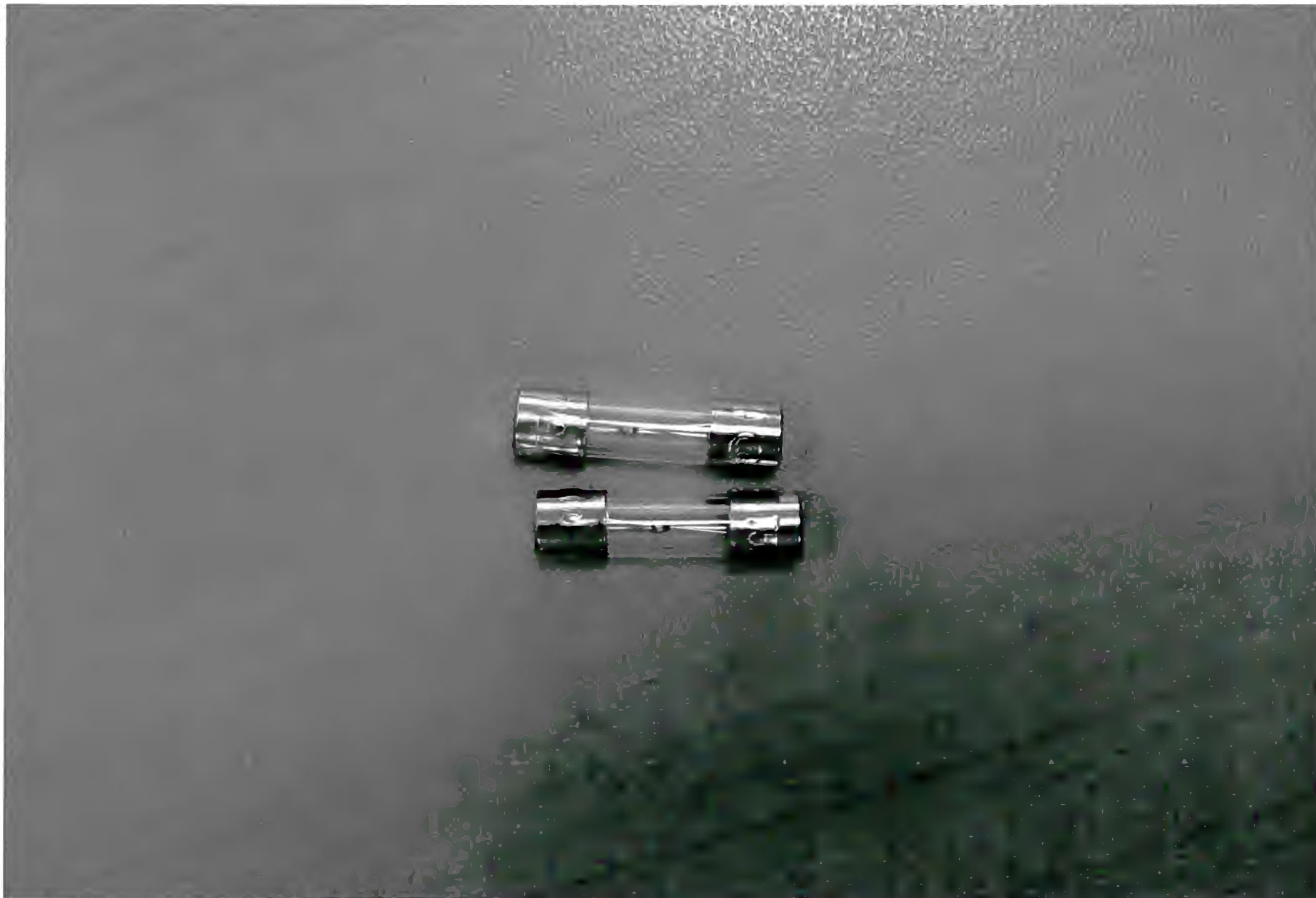
Рис. 7 – Предохранитель плавкий 5 А, Ø5x20 (2 шт.)
