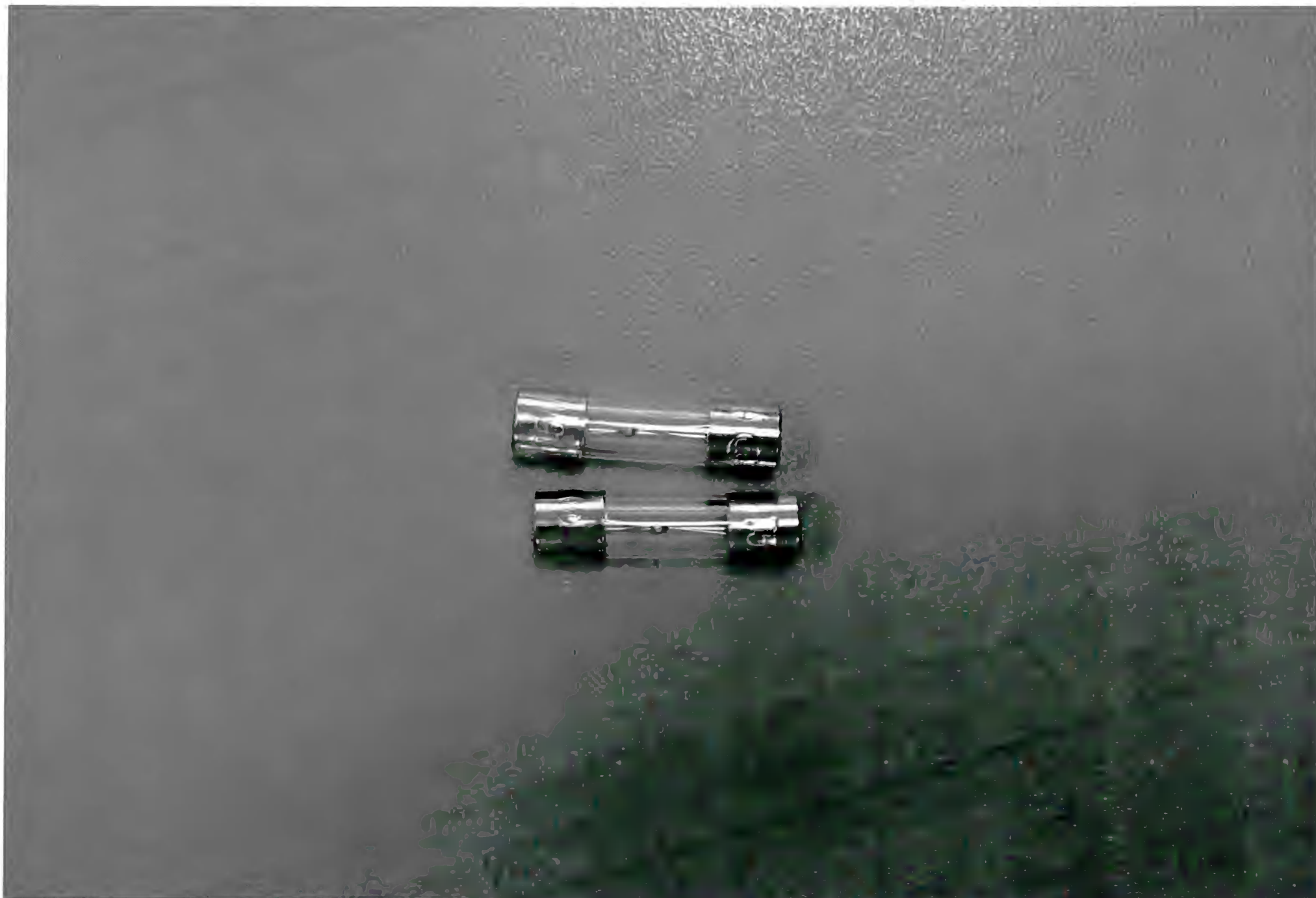
Рис. 15 – Предохранитель плавкий 5 А, Ø5х20 (2 шт.)
