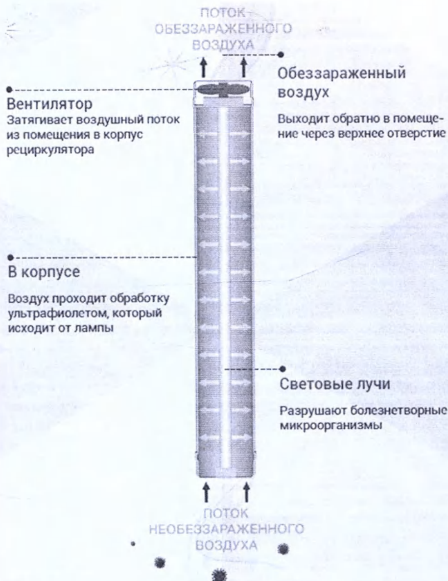
Рис. 4 – Устройство рециркулятора
