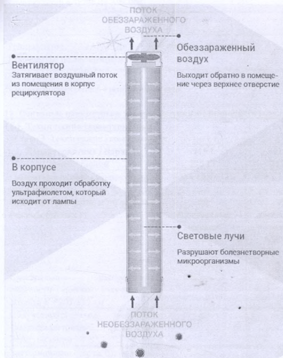
Рис. 3 – Устройство рециркулятора
