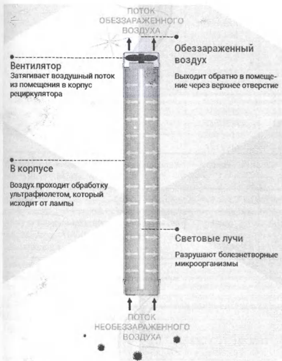
Рис. 9 – Устройство рециркулятора
