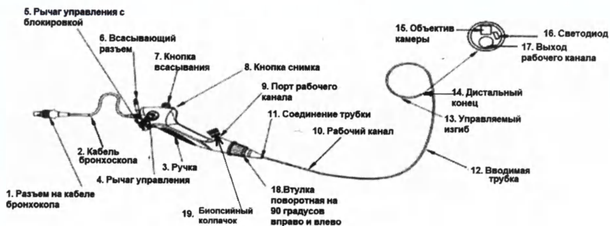
Рис.2а. Рабочие компоненты видеобронхоскопа
