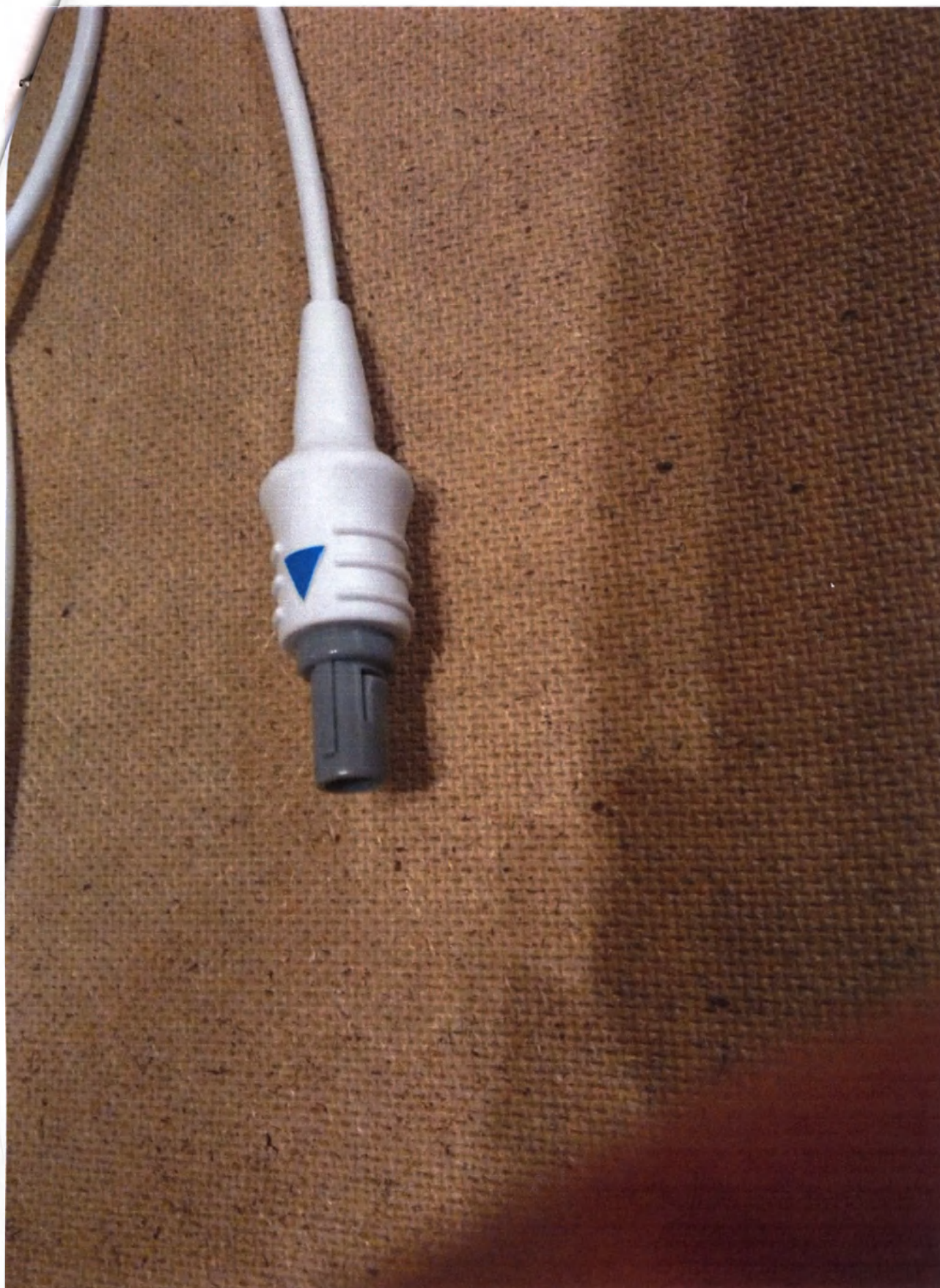
Штекер разъема для присоединения к видеопроцессору
