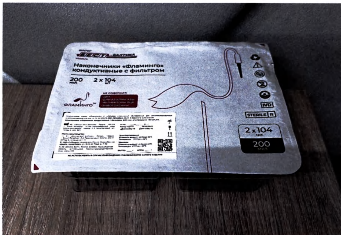
Рисунок 10 – Наконечники «Фламинго» кондуктивные с фильтром, 200 мкл, 2 штатива по 104 шт./уп.
