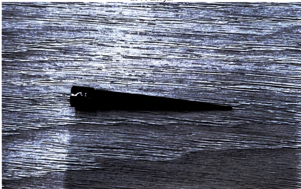
Рисунок 11 – Наконечники «Фламинго» кондуктивные с фильтром, 300 мкл, 5 штативов по 96 шт./уп.
