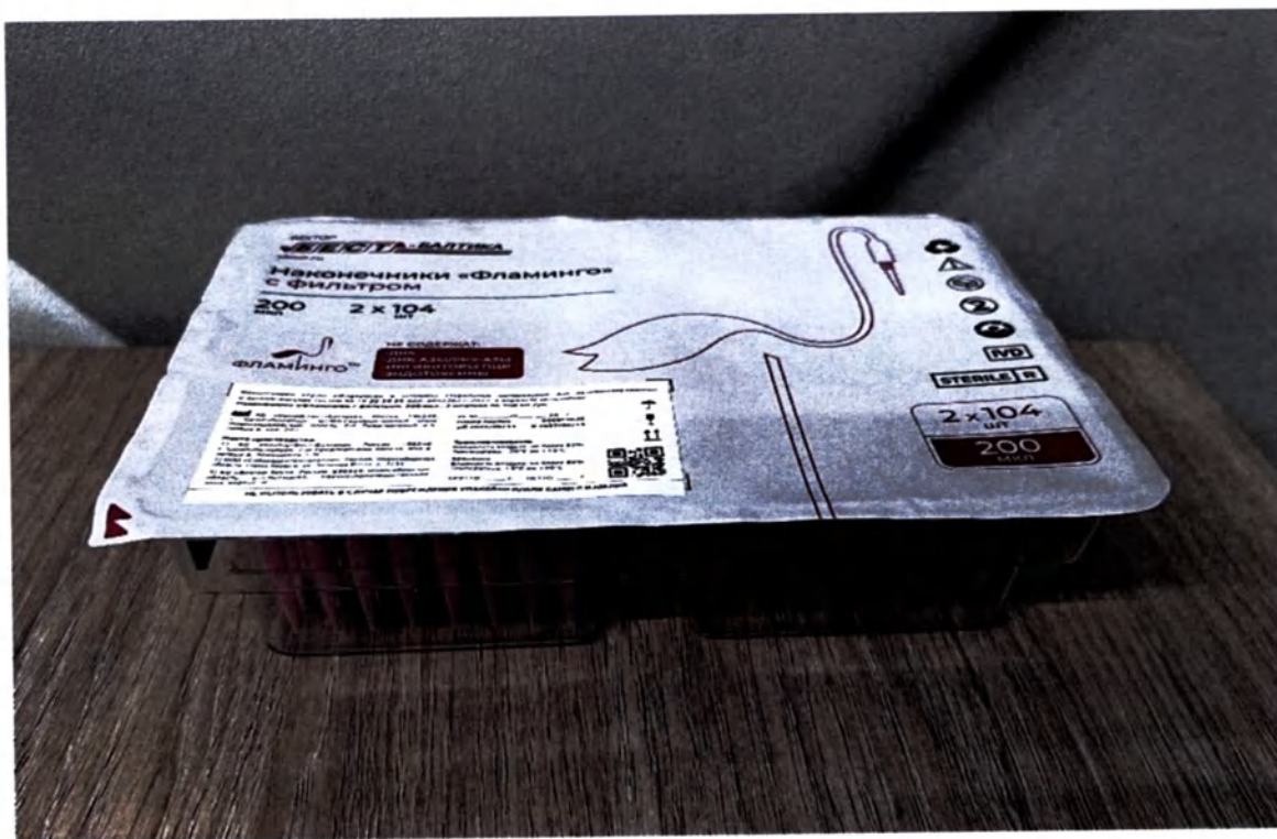
Рисунок 4 – Наконечники «Фламинго» с фильтром, 200 мкл, 2 штатива по 104 шт./уп.
