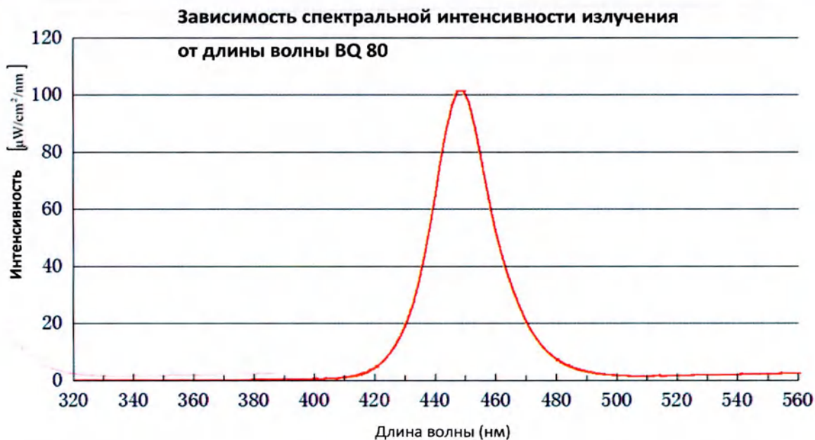
Рис. 6-6 Зависимость длины волны синего света от эффективной интенсивности излучения
