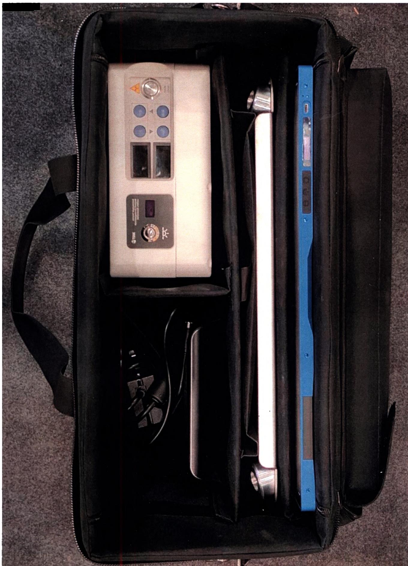
Аппарат медицинский рентгенодиагностический переносной «МИРАН» по ТУ 26.60.11-003-17942806-2022 артикул Б в собранном виде в транс- портном модуле
