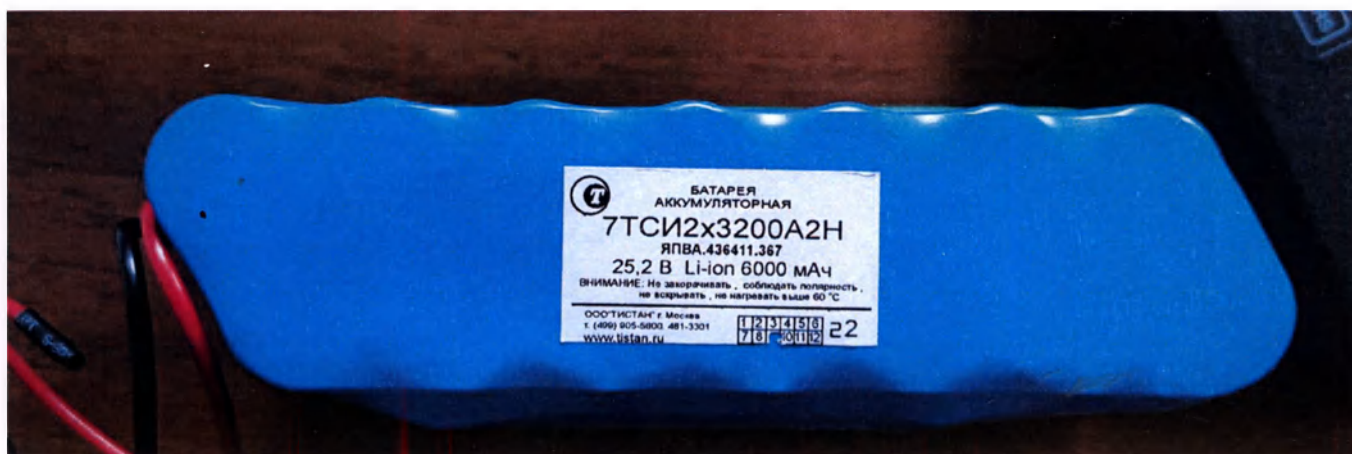
Аппарат медицинский рентгенодиагностический переносной «МИРАН» по ТУ 26.60.11-003-17942806-2022 артикул А: аккумулятор штатива
