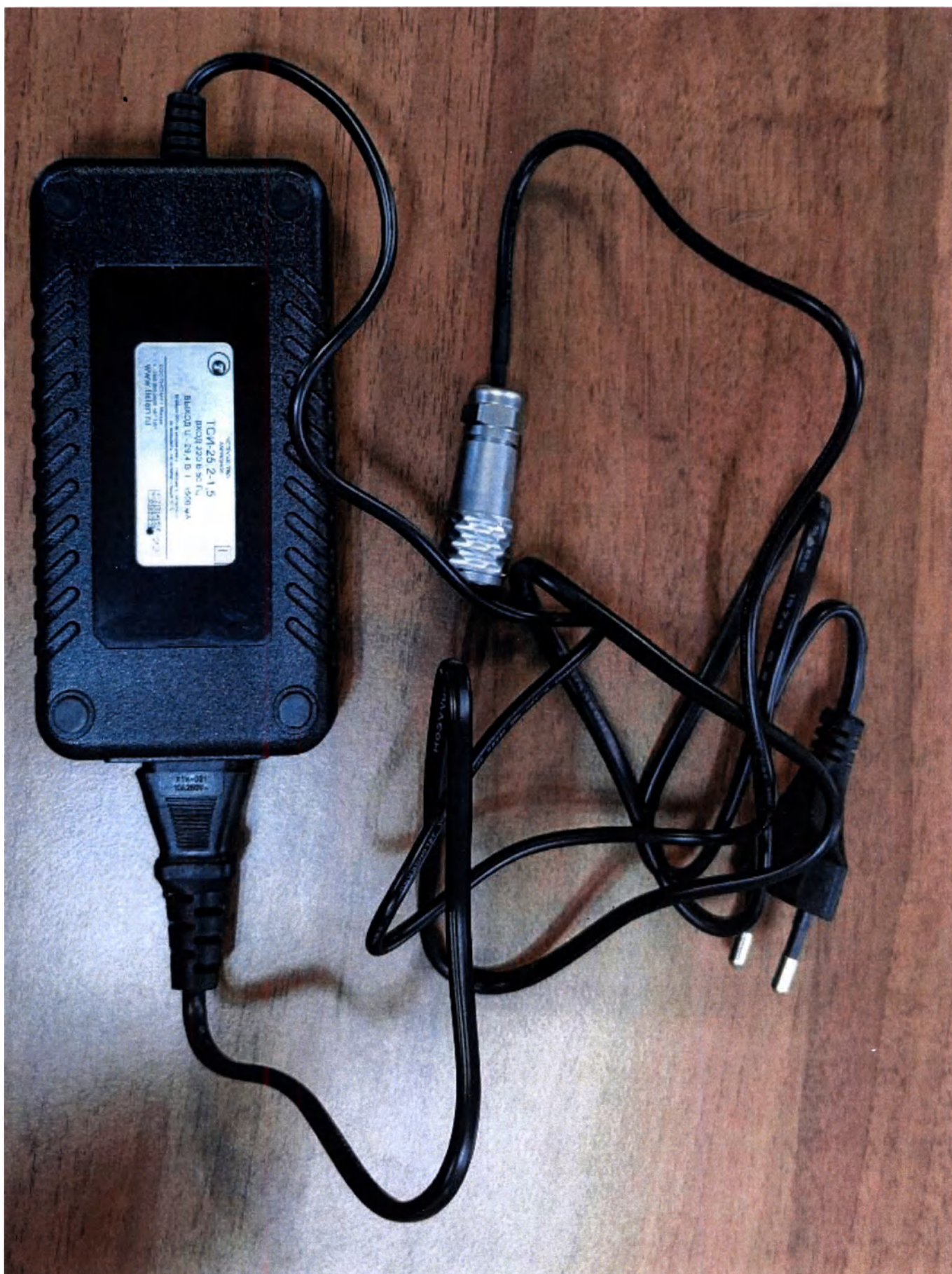
Аппарат медицинский рентгенодиагностический переносной «МИ-РАН» по ТУ 26.60.11-003-17942806-2022 артикул Б: Устройство зарядное аккумулятора излучателя рентгеновского
