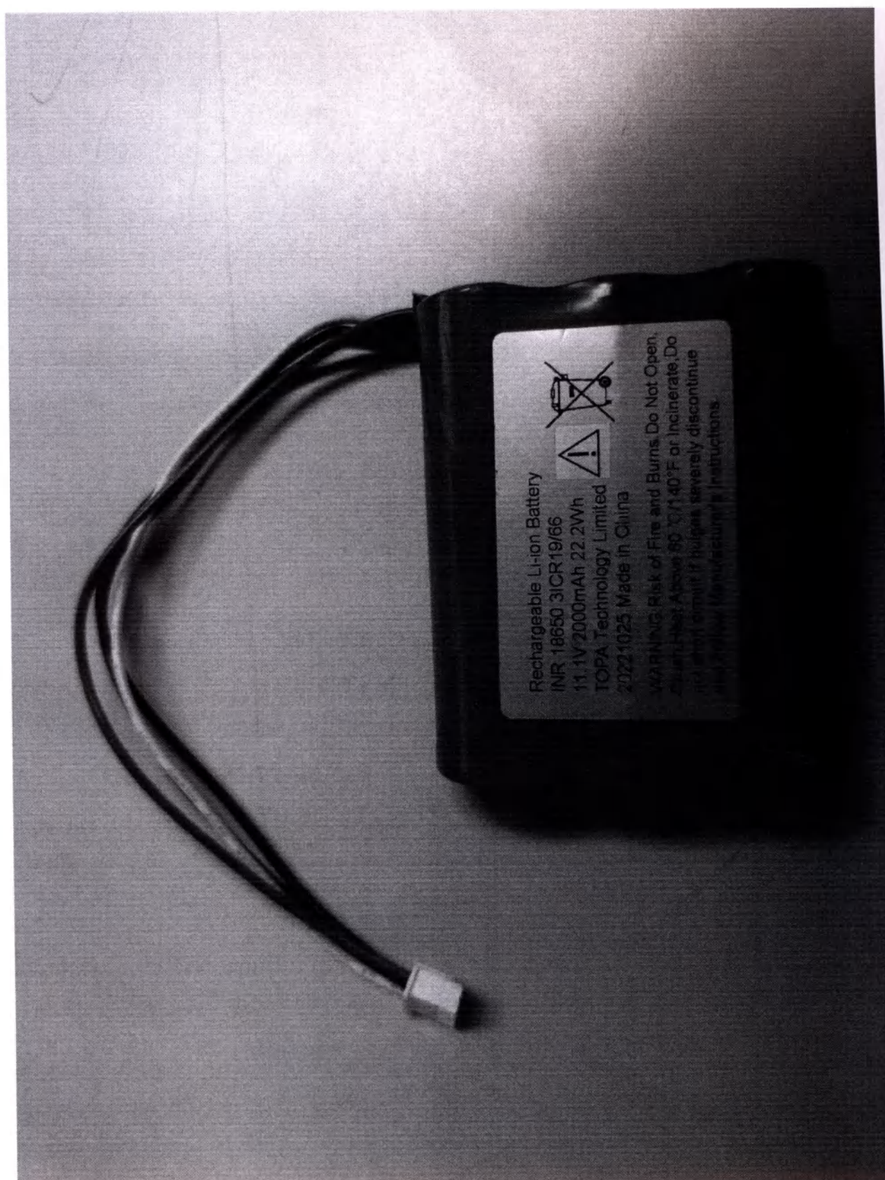
Насос инфузионный OneDis KL-8052N по ТУ 32.50.50-002-53199251-2023. Маркировка встроенной батареи
