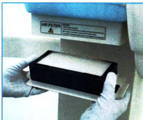
Рис. 11.4 – Осмотр и замена воздушного фильтра
