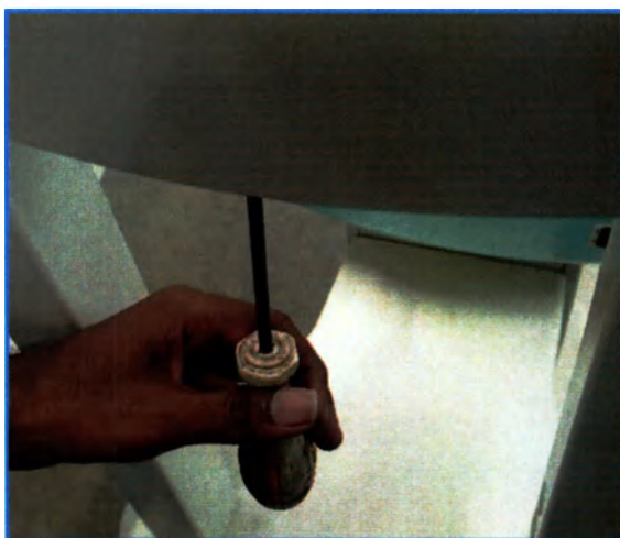
Рис. 5.11 – Снятие задней панели корпуса инкубатора
