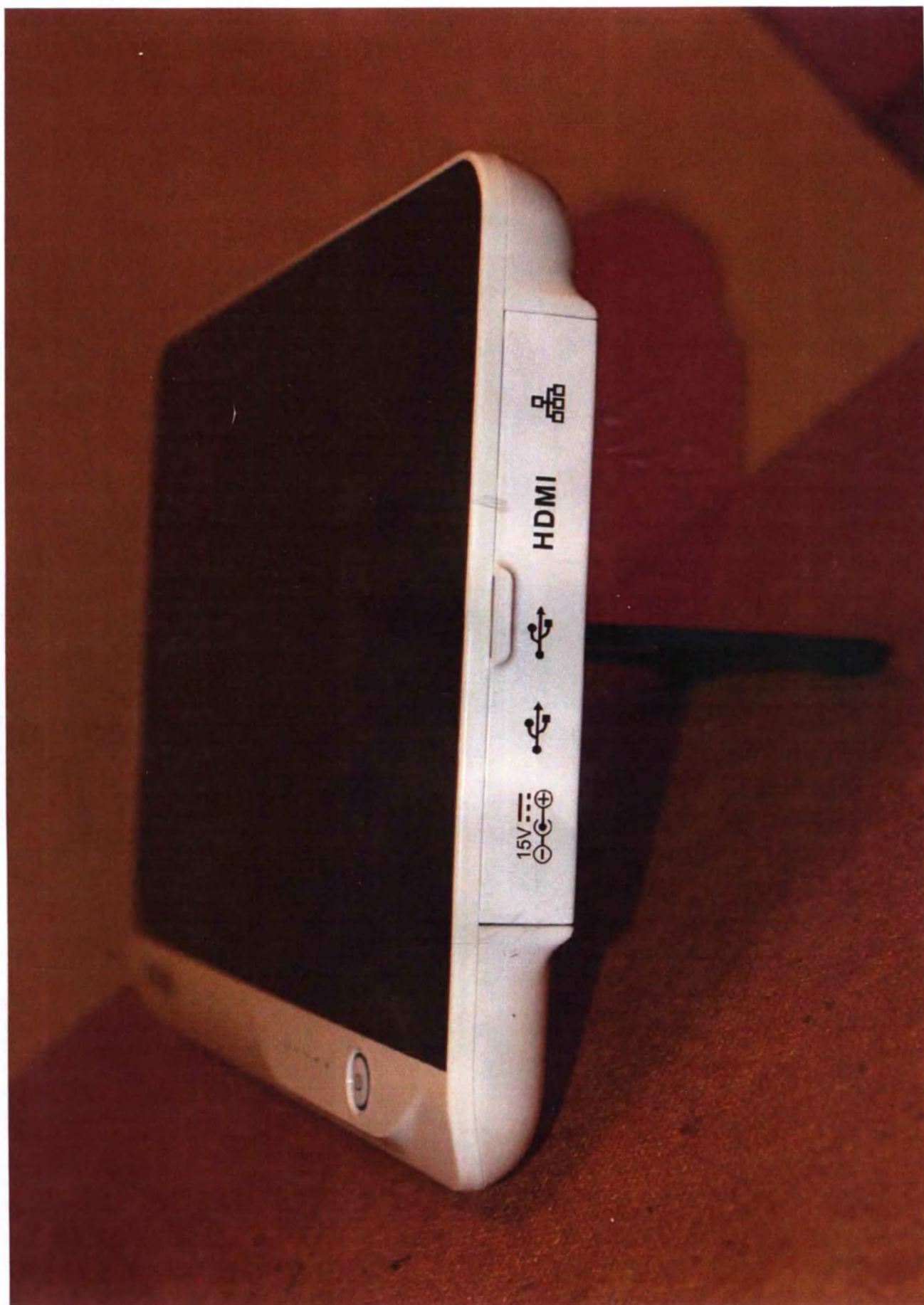
Порты для кабелей HDMI-DVI, HDMI и USB-кабеля и адаптера питания
