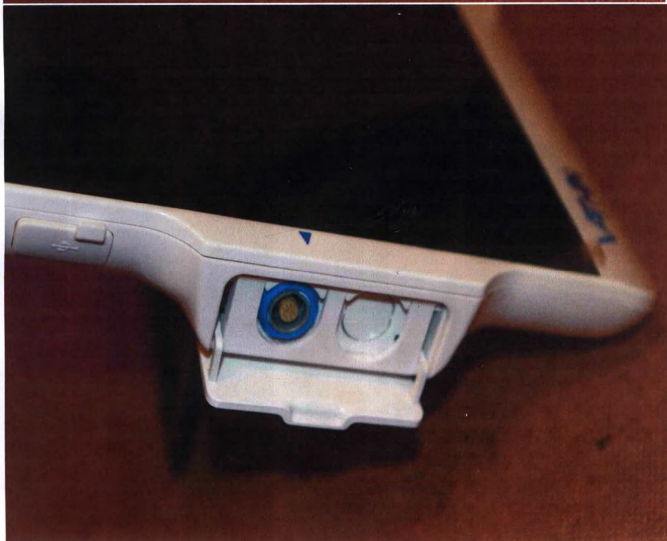
Гнездо разъема для подсоединения эндоскопа к видеомонитору
