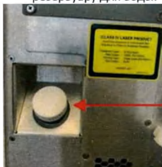
Горловина резервуара для воды
