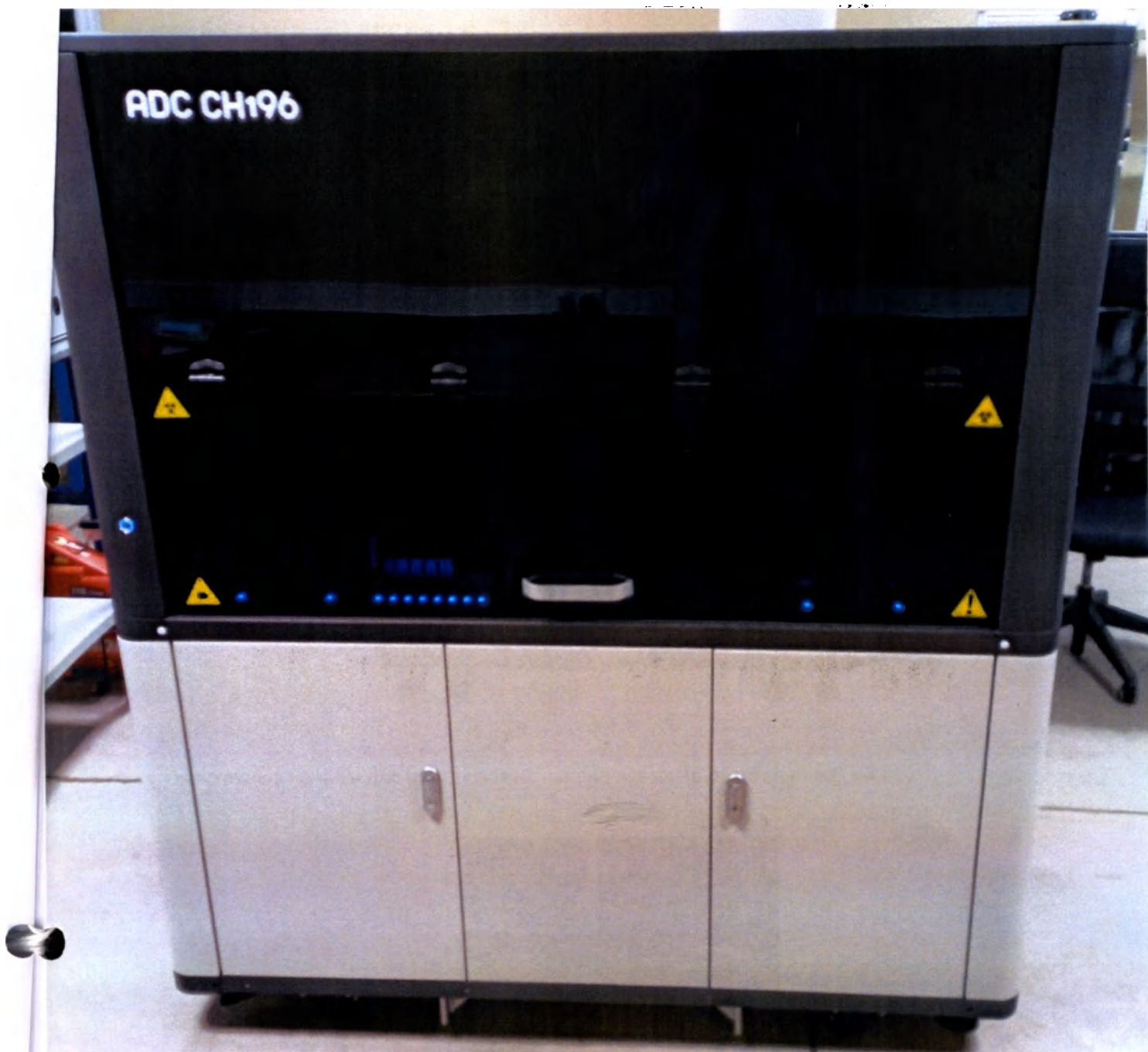
ПЦР-станция для автоматического выделения нуклеиновых кислот (Fully automated nucleic acid extractor) ADC CH-196, в составе. Общий вид.
