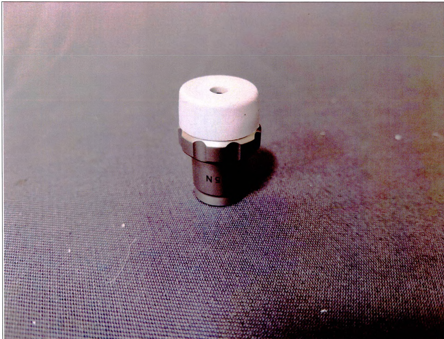
Рис. 69. Заглушка, с резиновым уплотнением, длина 25,5 мм, наружный диаметр 18 мм (10315N), в составе: заглушка, колпачок уплотнительный 50/4. Имеет схожий внешний вид, отличается размером. Заглушка, с резиновым уплотнением, длина 15,5 мм,
