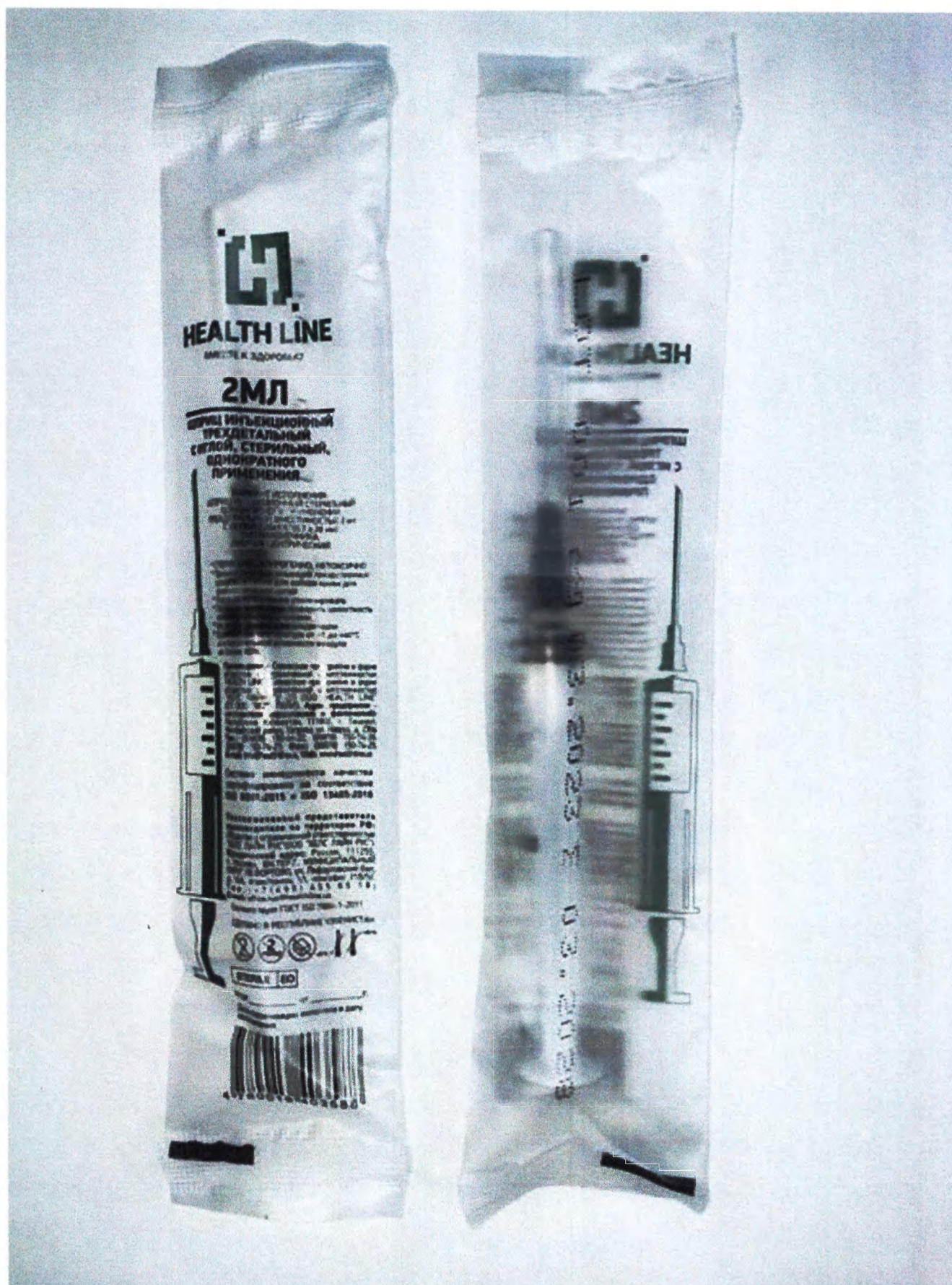
Рисунок 3.2 Шприц инъекционный стерильный, однократного применения трехдетальный вместимостью 2 мл с иглой 22G x 1½" (0,7x38 мм). Тип наконечника: Луер 6% центрический; Индивидуальная стерильная упаковка из полиэтилена
