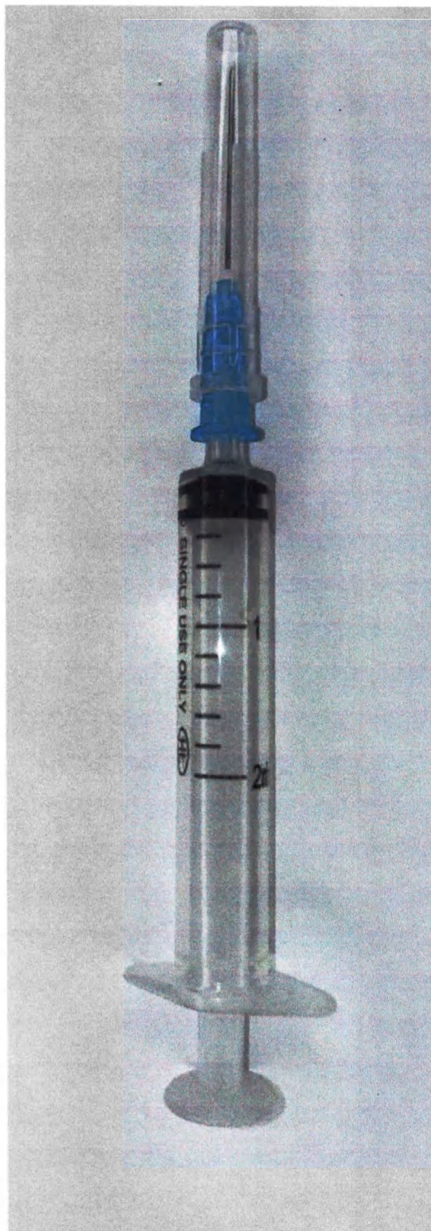
Рисунок 1. Шприц инъекционный стерильный однократного применения трехдетальный вместимостью 2 мл с иглой 23G x 1" (0,6x25 мм). Тип наконечника: Луер 6% центрический; Общий вид.
