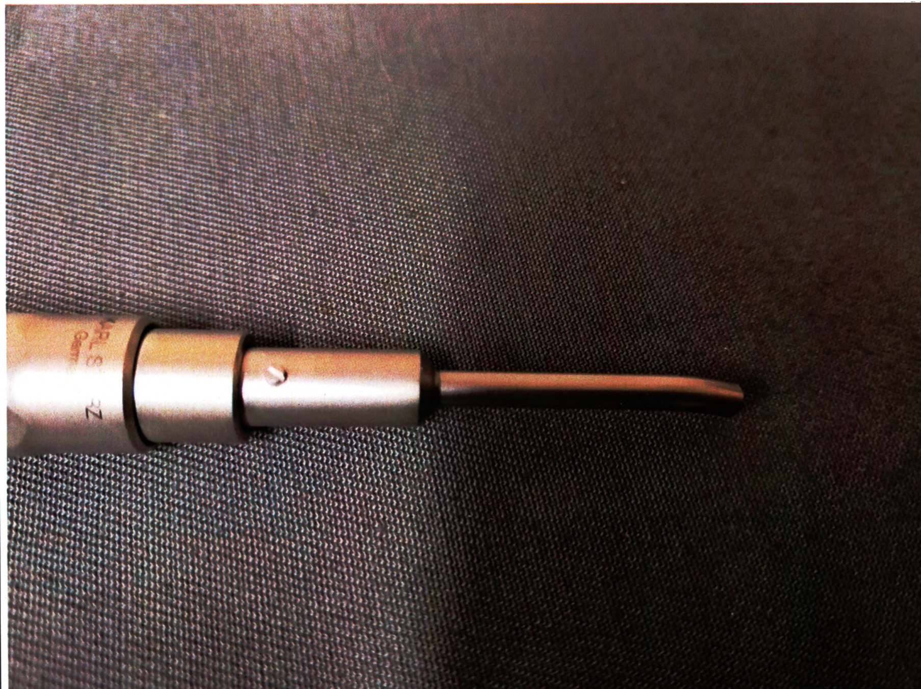
Рис. 24. Стержень осветительный с соединением для волоконнооптического световода, диаметр 3 мм, длина 9 см
