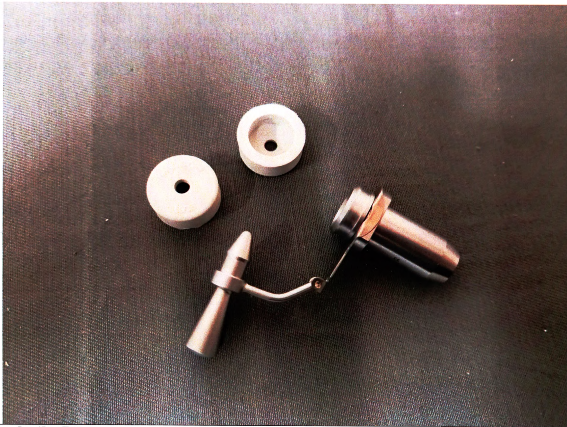
Рис. 47. Переходник для лупы, в составе: переходник – 1 шт., колпачок уплотнительный (50/3,6) - 2 шт.
