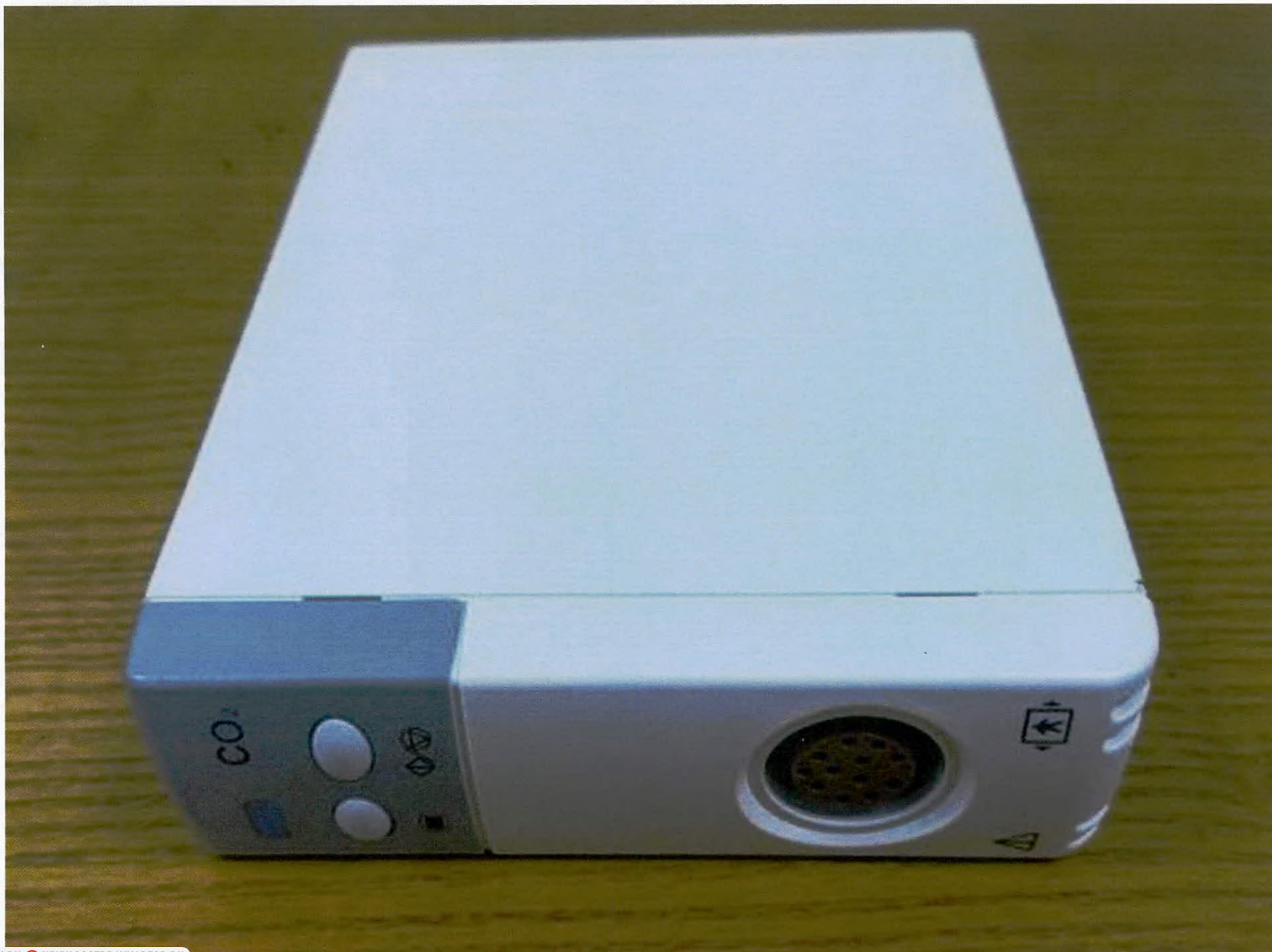
Вставной модуль CO 2 в основном потоке
