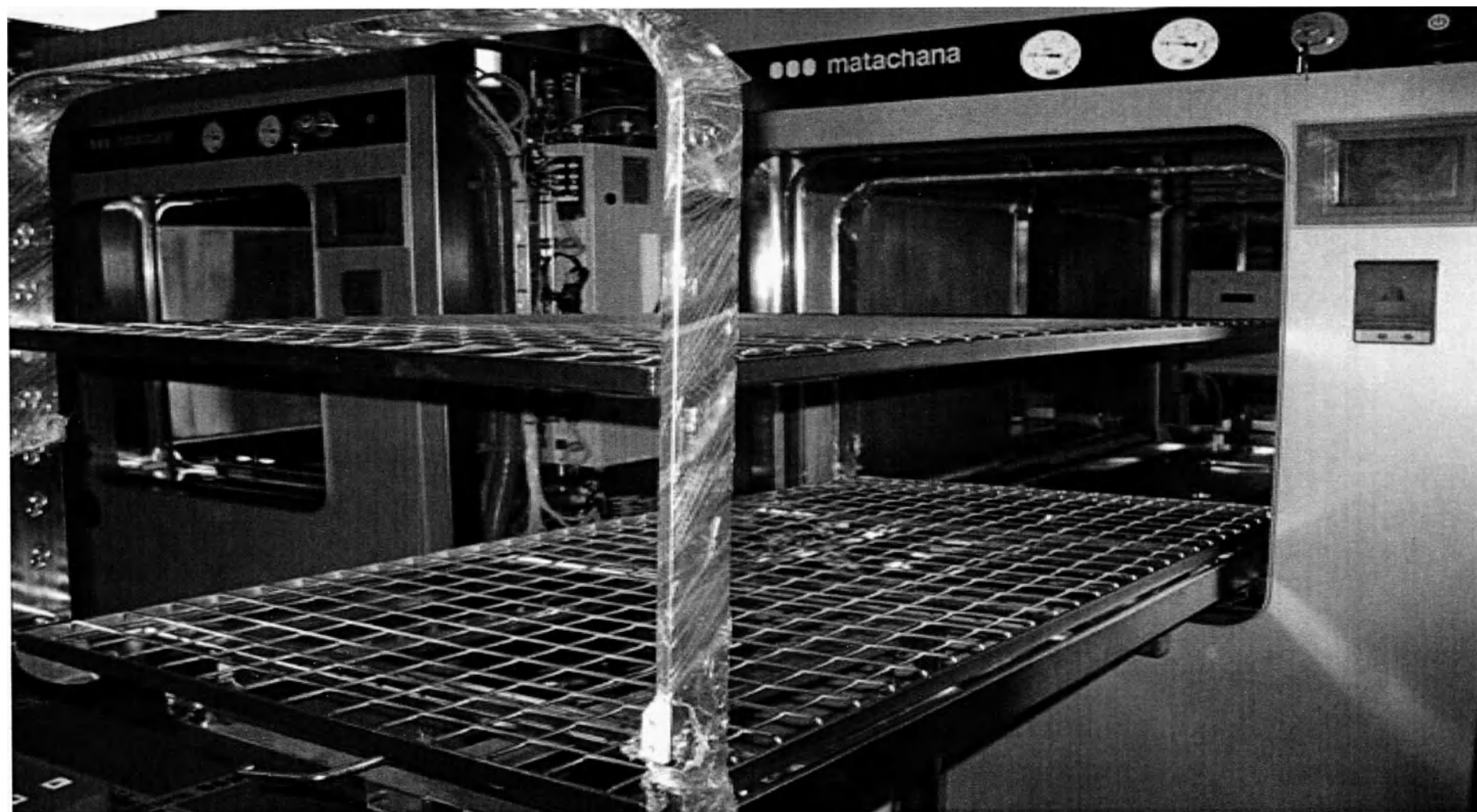
Внутренние двухуровневые загрузочные платформы с регулируемыми по высоте направляющими и 2-мя полками
