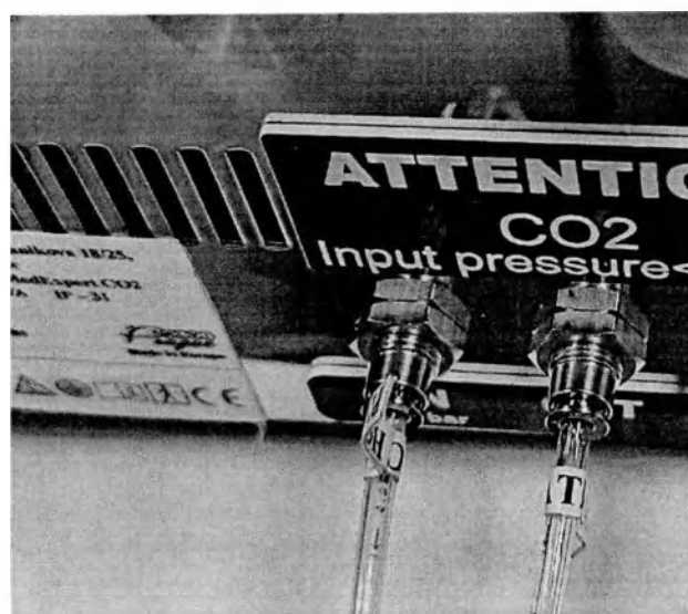
Рисунок 17 – Подключение пневмошланга для подачи газа CO 2 от баллона к аппарату к входу IN, на задней панели аппарата
