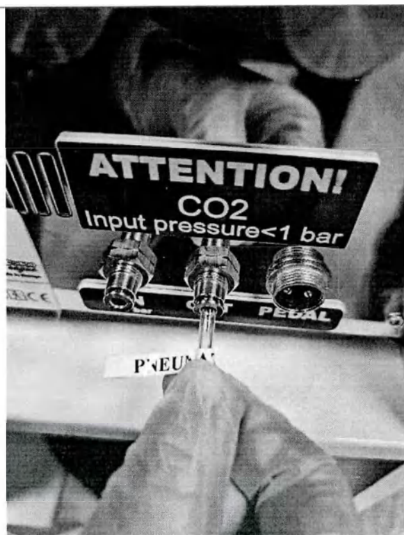
Рисунок 7 – Подключение пневмошланга для подачи газа CO 2 от аппарата к игле к выходу OUT, на задней панели аппарата
