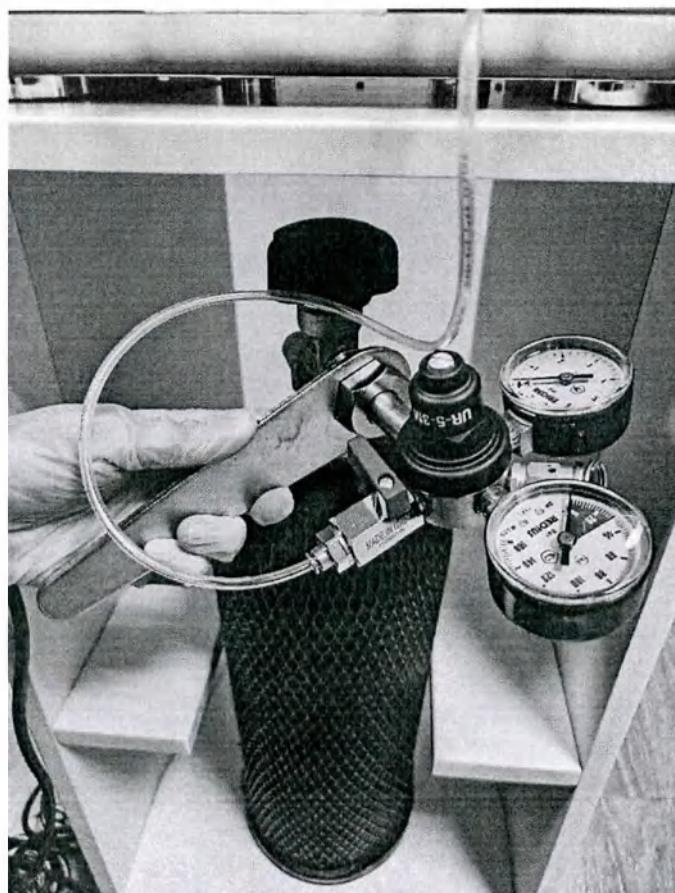
Рисунок 13 – Подключение регулятора к баллону с газом CO 2
