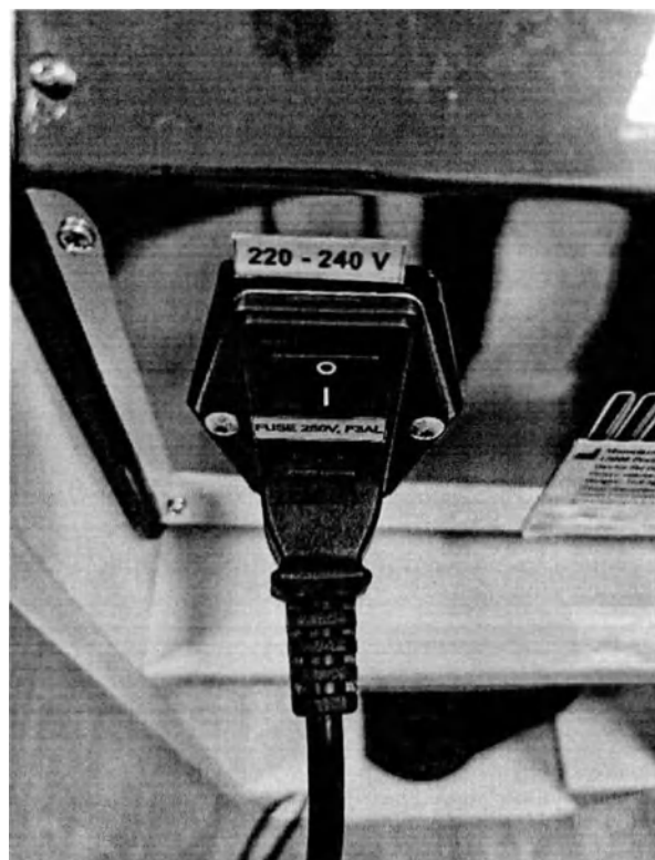
Рисунок 4 – Подключение аппарата к электросети при помощи шнура питания
