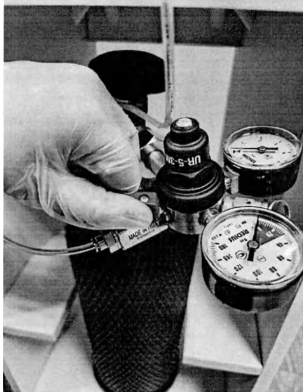
Рисунок 18 – Регулировка давления газа CO 2
